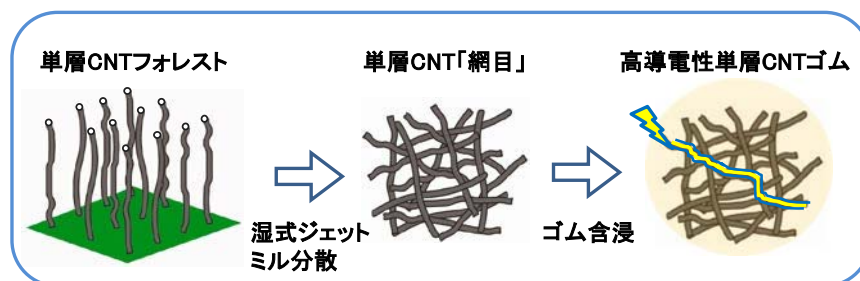
図 II-11 単層 CNT 「網目」構造制御技術
