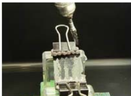
図12 CNT複合材料の切削試験 49)
