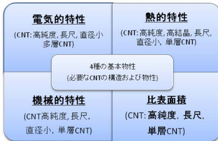
図 2.2.1.4.2-7 4つの基本特性に対応するCNT構造
