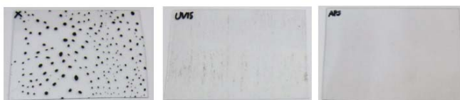
図 2.2.2-48 表面処理したPET上での水接触角の測定結果
