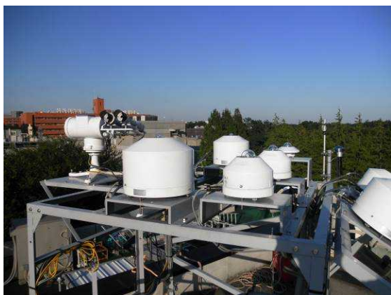
図 4-3 日射計の比較観測（左）と分光放射計の交換作業（右）
