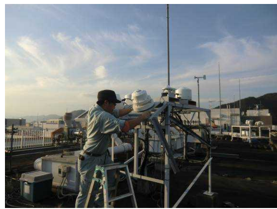
図 4-3 日射計の比較観測（左）と分光放射計の交換作業（右）
