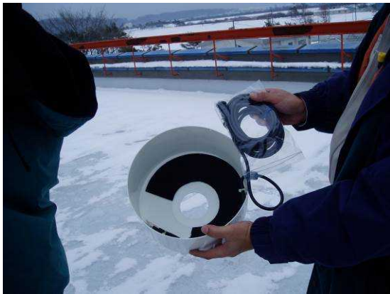
図 4-2 長沼地点の日射計に取り付けられたヒータ（左）と積雪時の写真（右）
