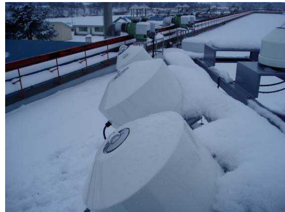
図 4-2 長沼地点の日射計に取り付けられたヒータ（左）と積雪時の写真（右）
