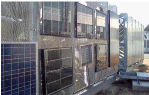
屋外サイトに1年間設置した 50cm角モジュール(フジクラ)
