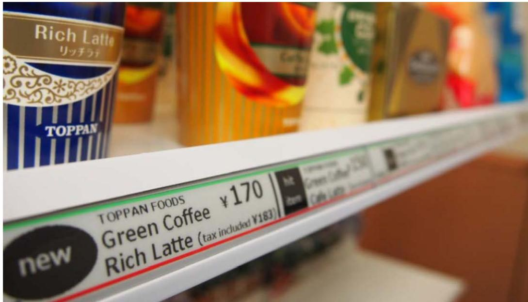
図IV-2.2.1-3 レール型電子棚札プロトタイプ
