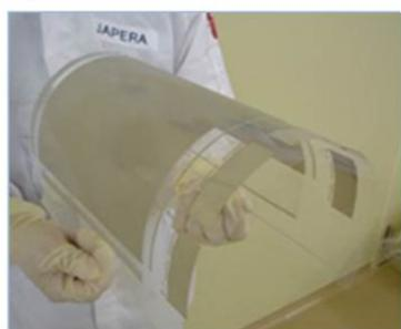
試作した全印刷TFT
