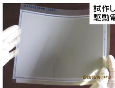
試作した全印刷TFT駆動電子ペーパー
