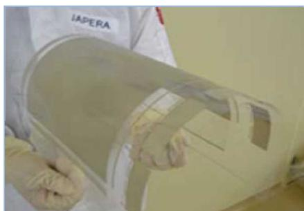
試作した全印刷製造TFTシート
