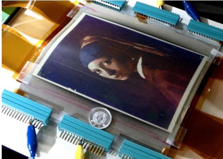
図Ⅲ-2.3.2-7 6インチ積層型ECDフレキシブルパネルの試作結果
