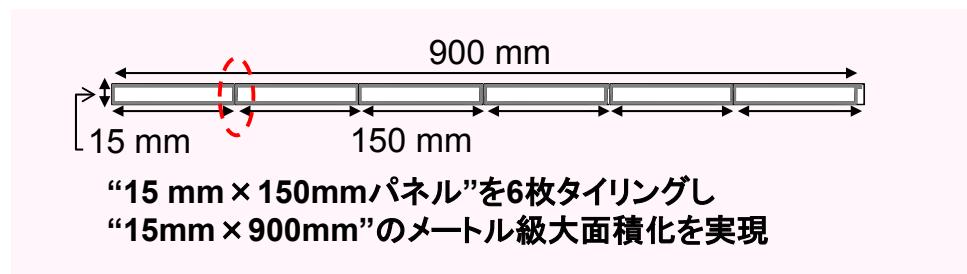
レール型ESL(電子棚札)の試作展示例
