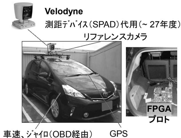
図Ⅲ.2.1.1-9 FPGA プロトと実車評価環境
