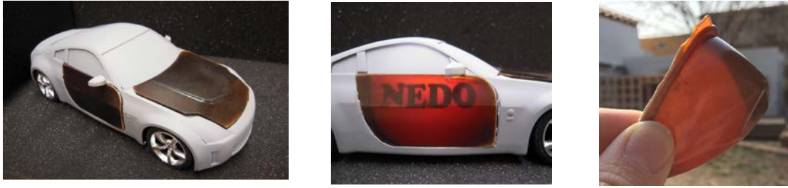
図Ⅲ-2.1.2-9 リグノ CNF を用いた高植物度・高弾性低熱膨張 3次元成形体
