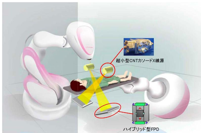
動体追跡が可能な高精度 X 線照射装置の概念図
