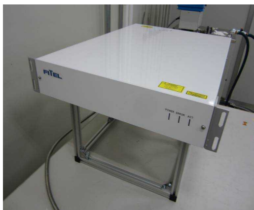
図Ⅲ-1.5 QCW ファイバーレーザー装置の外観
