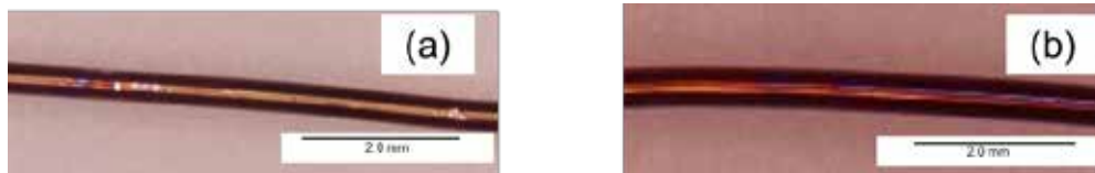
図 - (1)-2-3-2.3 活性層塗布芯材の光学顕微鏡画像
