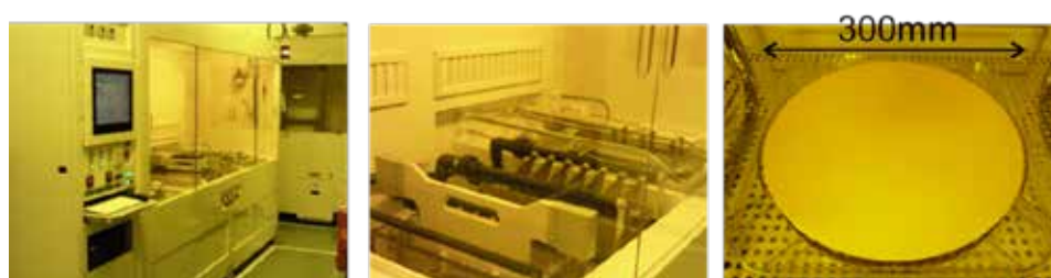
図 - (5)-5-2-2.2 300mm ウェハ対応 Cu めっき装置
