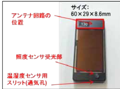
図 - (1)-3-4.1 最終試作端末（東工大開発太陽電池搭載版）
