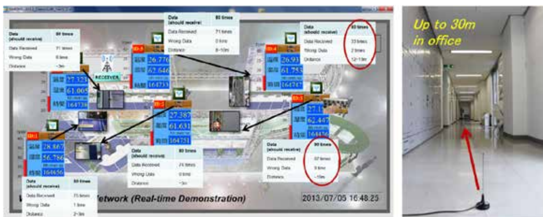
図 -(5)-2-2.4 プロトタイプモジュールのセンサ端末機能評価結果
