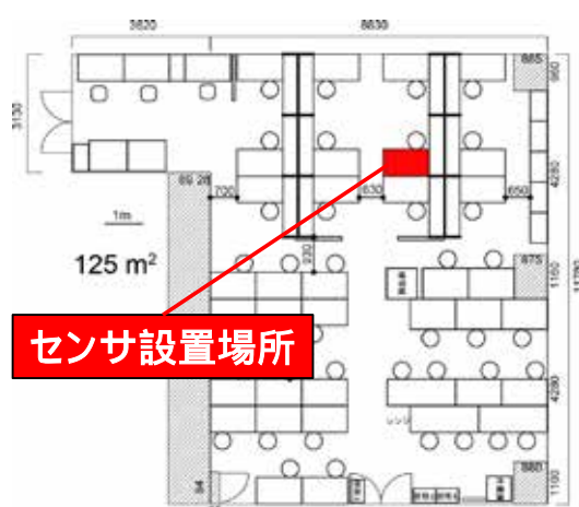
図 -(3)-3.1 実証実験を行った部屋の見取り図およびセンサ設置場所
