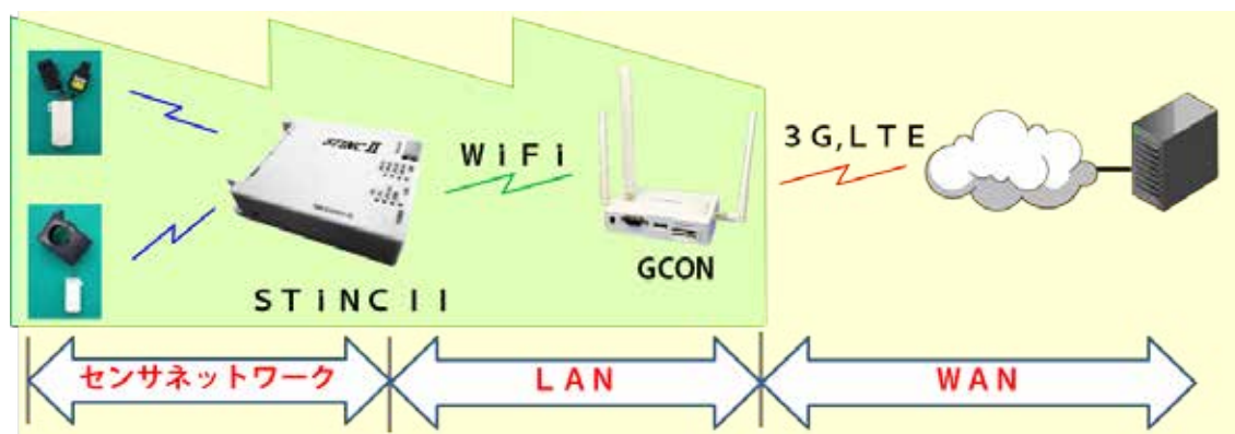
図 - (4)-5-1-1.1 グリーンセンサネットワークシステム構成図
