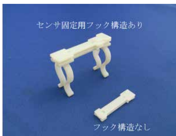
図 - (3)-3.2 射出成形により作製したクランプ留具
