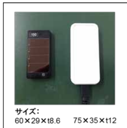
図 - (5)-7.1 最終試作機端末 (左) と小型化した受信機 (右)
