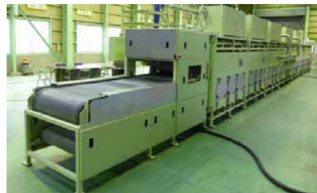
密閉式ガスヒータ搭載連続炉(実証機)
