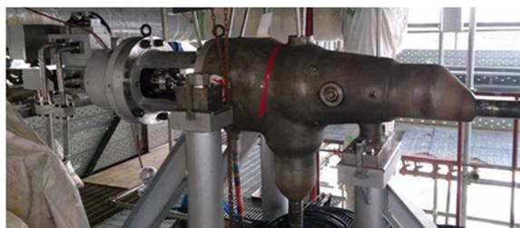
図 50 タービン制御弁
