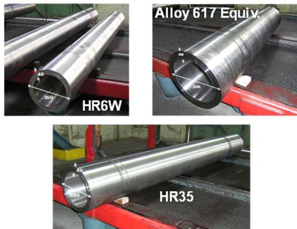
図 11 試作大径管 (外径 350mm)
