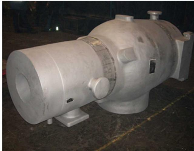
図 39 弁ケーシング (Alloy625, 約 9ton)
