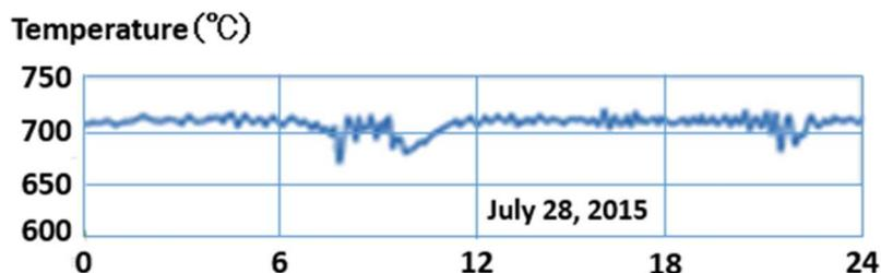
図 44 700°C 級過熱器出口蒸気温度の例
