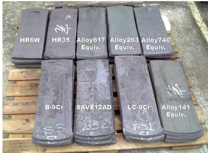
図 9 ボイラ試験用板材料
