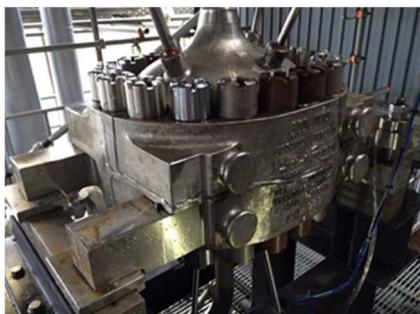
図 51 タービン内部ケーシングモデル
