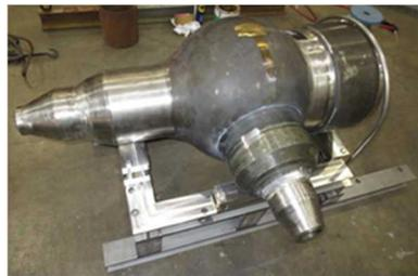
図 49 タービンバイパス弁（ボイラ起動弁）
