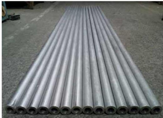
図 13 試作小径管（過熱器用）
