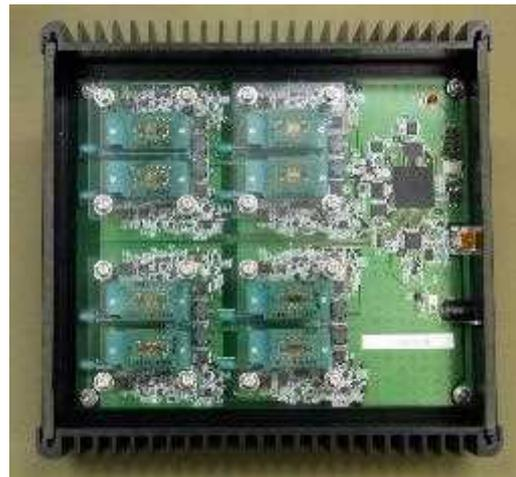
図 2.1-49 8 個の MTJ 素子を同時に測定し可能な反転確率測定器
