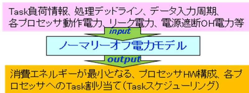
図 2.6-5 電力モデルを用いたタスクスケジューリング
