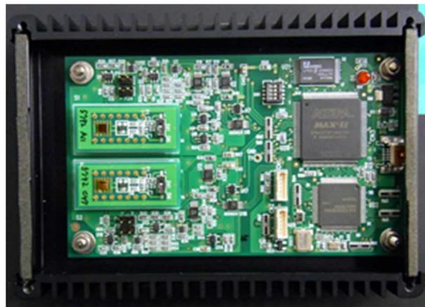
図 2.1-46 反転確率評価装置
