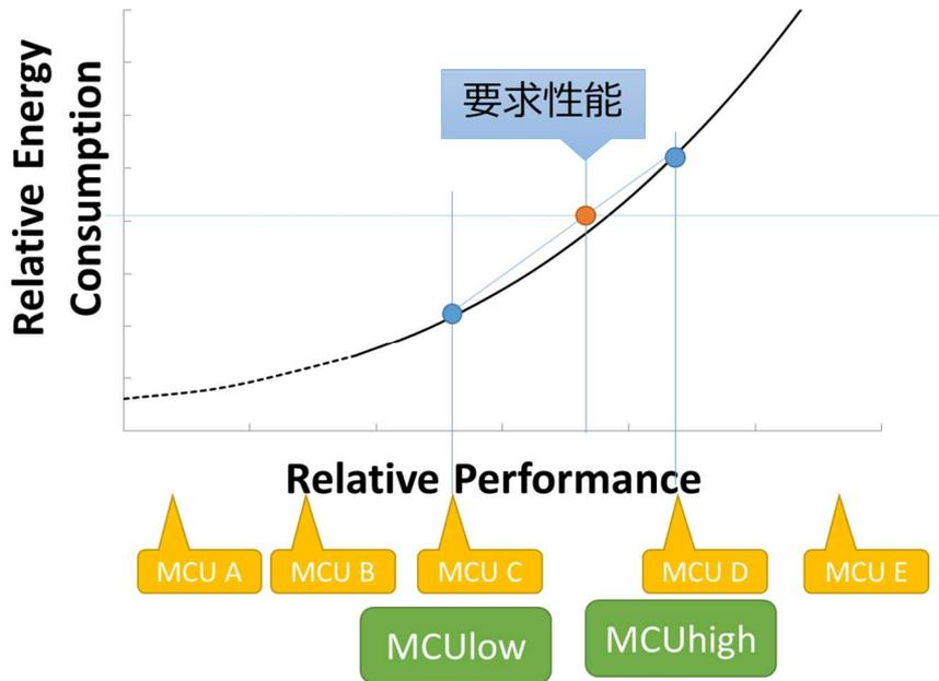
図 2.6-14 最適な MCU 構成
