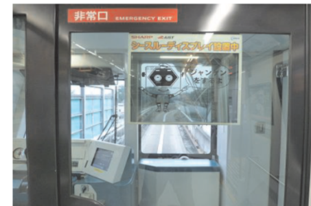
新車両内に透過型ディスプレイを設置した様子
