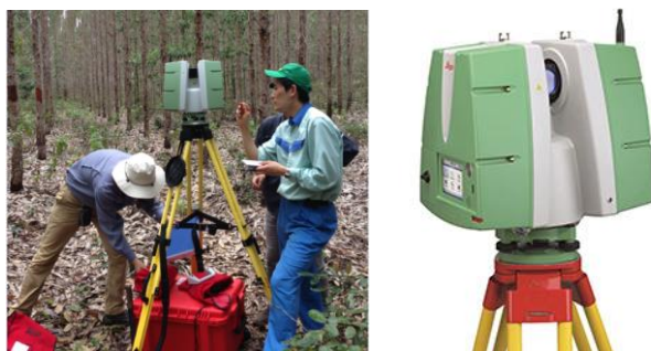
図 2.1.3-33 本研究で用いた地上レーザーセンサー（Leica Scan Station P20、右図）と現場作業の様子（左図）
