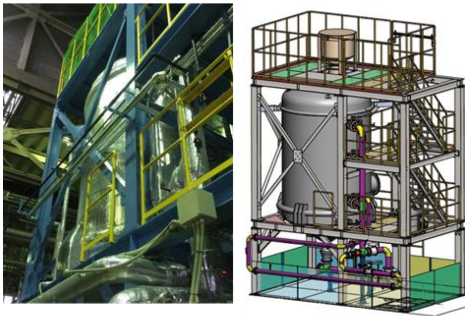
図 2.4.3-9 20 m 3 スラリーハンドリング装置写真と概略図 (日揮技術研究所設置)
