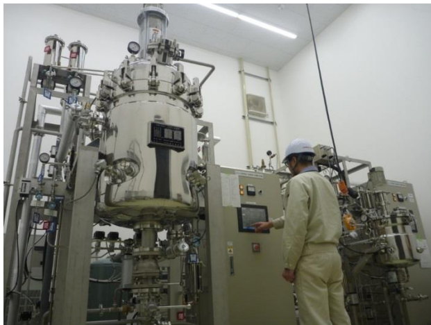
図 2.4.3-7 SSCF ベンチスケール装置 (左:200 L SSCF 装置、右:30 L SSCF 装置)
