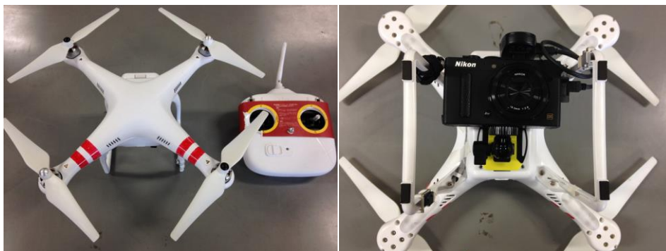
写真 2.1.3-10 本研究に用いた Phantom 2 と装着したカメラ
