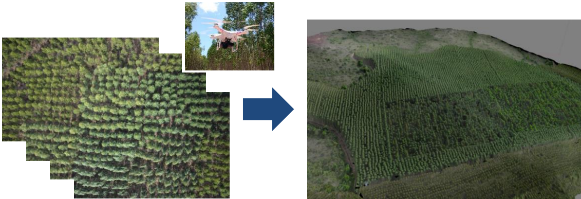
図 2.1.3-41 3次元データ変換(左図: UAVによる空撮によって取得された連続撮影写真、右図: 30ha以上の対象地をPhotoscan Professionalによって変換後の3次元データ)
