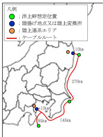
図 3-2-1 洋上系統の概念図
