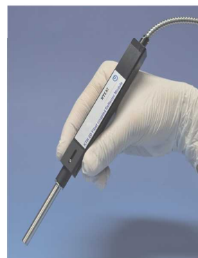
図1. KTN光スキャナーを組み込んだ硬性内視鏡
