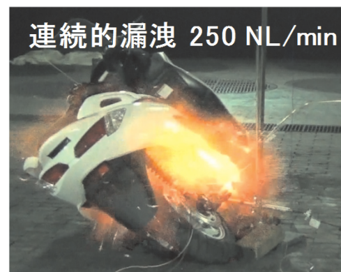
FC二輪車の水素センサー取付け要件に関わる水素漏洩試験
