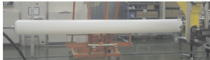
大型リアルスケールたわみ検証状況 （八千代工業）
