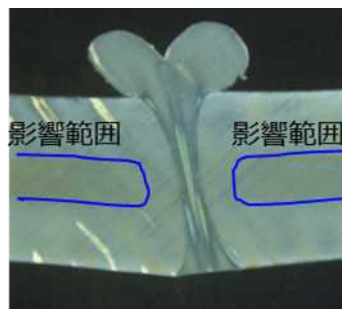
図3-14 溶着部水素曝露試験結果
