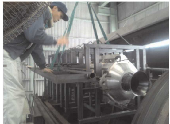
図 5 アルミ型セッティング状況
