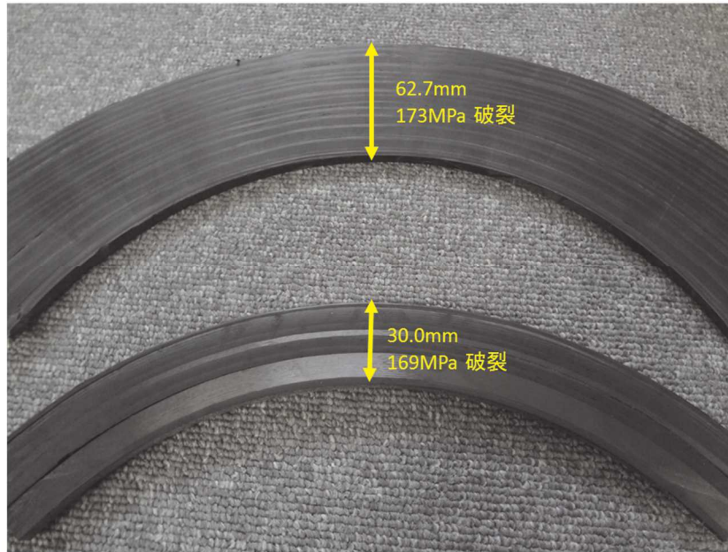
図 33 30L CFRP 補強層切断面
