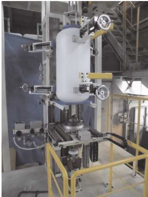
図 9 新型 縦型融着機 融着状況
