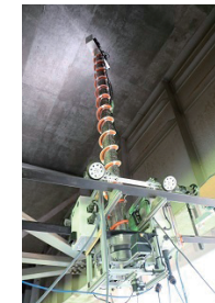
伸縮するZ軸アームでカメラを格間内に伸ばして必要角度から撮影
