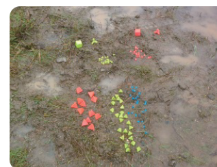
降灰量を上空から観測するための投下型降灰厚スケール
