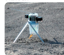
ドローンから吊下して使用する表面流確認デバイス
