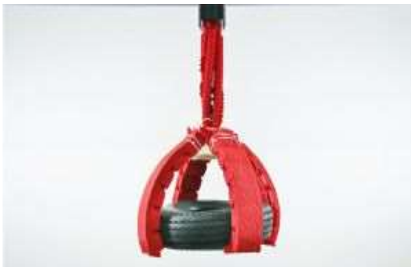
折り紙に着想を得た人工筋肉は、単に空気圧や水圧を適用するだけで、自重の 1,000 倍の重量までの物体を持ち上げることができる。Credit: Shuguang Li / Wyss Institute at Harvard University / MIT CSAIL
