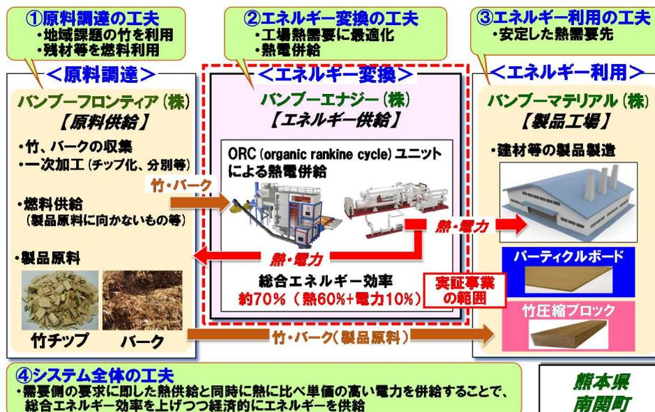
※ORCユニット(organic rankine cycle): 蒸気タービンと違い水でなくシリコンオイル等を熱媒体として利用する。取扱圧力が低く機械的ストレスが低いなどの特徴がある。
