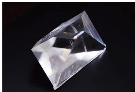
大阪大学が作製した重量約600gの大型CLBO結晶。これから、波長変換素子を切り出す。
