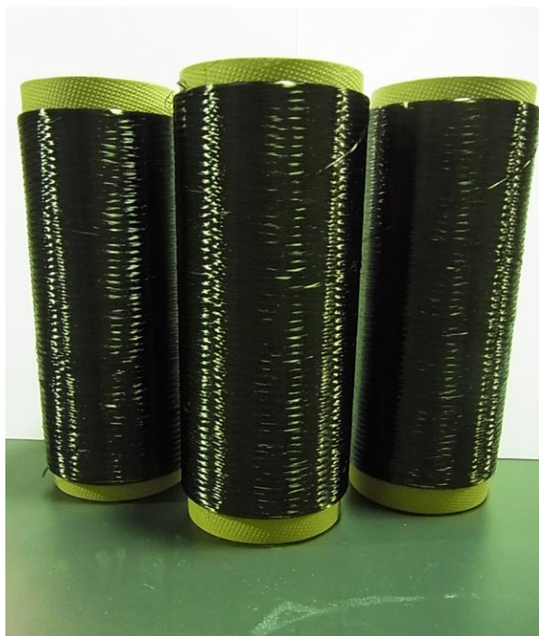
図7. バッチ式設備で試作したSiC繊維の外観
