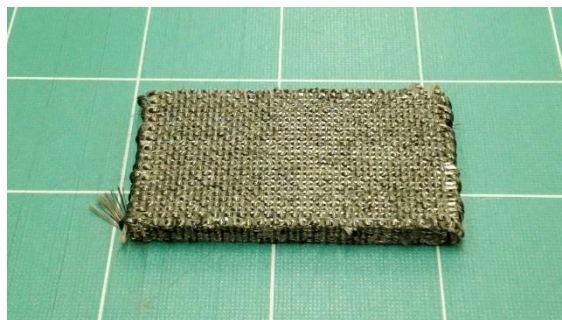
写真3 第3世代 SiC 繊維を用いた3次元プリフォーム
