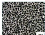
今回開発したファイバーレス高強度高断熱性材料の外観(左)と電子顕微鏡画像(右)
