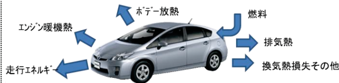
ハイブリッド車のエネルギーフローの一例(冬場)
