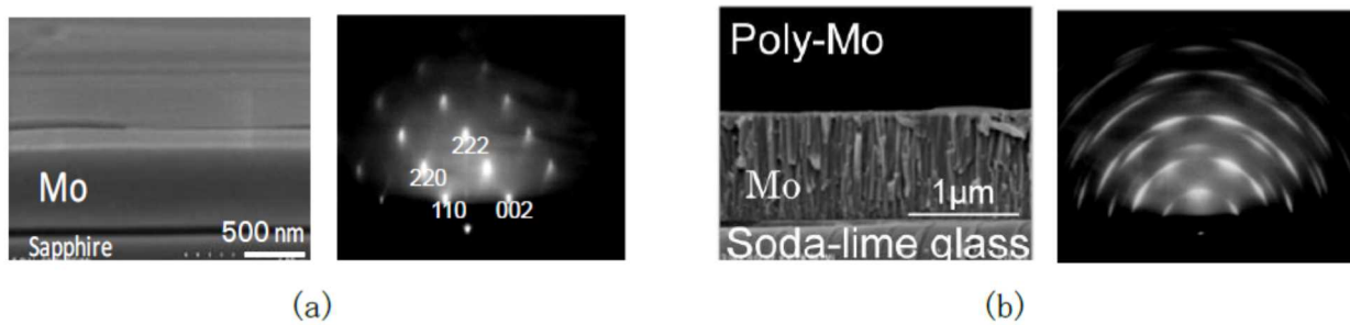
図Ⅲ-2-(ニ)-D-8 本研究で得られた(a)エピタキシャル Mo 薄膜、および(b)従来の多結晶 Mo 薄膜の SEM 写真および反射電子回折像
