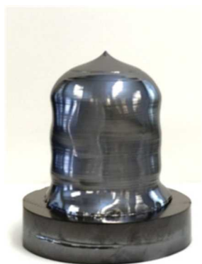
図Ⅲ-2-(イ)-E-1 育成したシリコン単結晶 図Ⅲ-2-(イ)-E-2 シリコン鏡面ウェーハ
