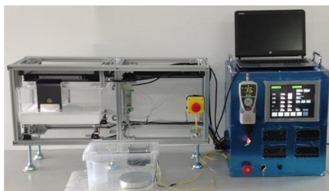
図III-2- (ロ) -1 -②-a-21 タカノ㈱にて開発のローラー型 ELO 装置
