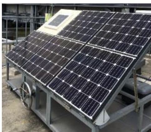
(左) 図Ⅲ-2-(ホ)-2-⑥-1 理科大に導入した屋外評価装置の外観。 (右) 図Ⅲ-2-(ホ)-2-⑥-2 算出した参照基準用 I-V 特性と実測 I-V 特性の比較結果。
