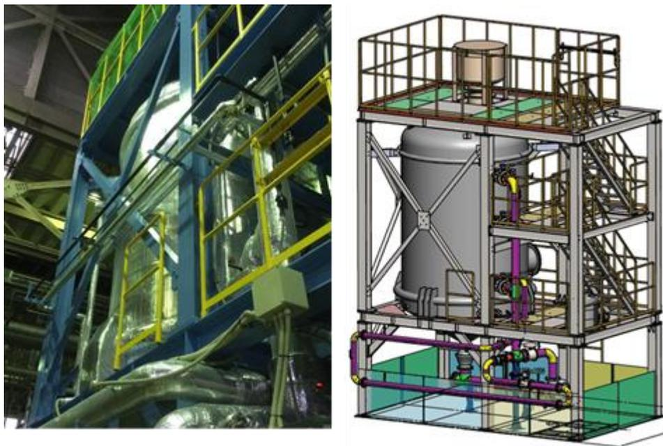
図 2.4.3-9 20 m<sup>3</sup> スラリーハンドリング装置写真と概略図 (日揮技術研究所設置)
