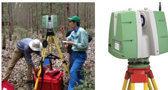
図 2.1.3-33 本研究で用いた地上レーザーセンサー（Leica Scan Station P20、右図）と現場作業の様子（左図）
