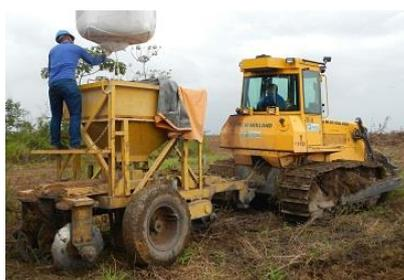
写真 2.1.3-6 ブルドーザ搭載型施肥機
