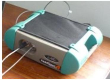
写真 2.1.3-8 携帯型分光放射計 (FieldSpec)
