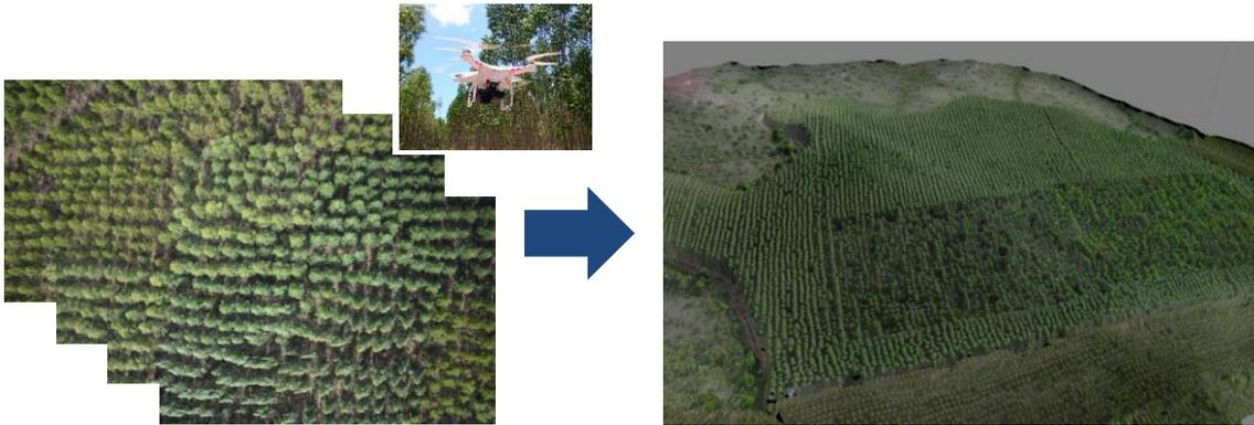
図 2.1.3-41 3次元データ変換(左図: UAVによる空撮によって取得された連続撮影写真、右図: 30ha以上の対象地をPhotoscan Professionalによって変換後の3次元データ)
