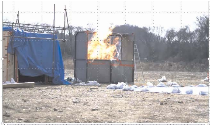
高速度カメラで撮影した模擬ベランダの火炎 (漏洩開始後13分で点火)
