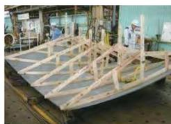
曲げ型を使った測定作業
