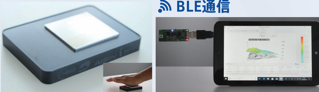
FAST材料を用いた小型温度差発電モジュールを内蔵したIoT機器の試作機
