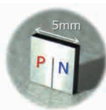
5mm P型およびN型の Si系クラスレート焼結体 U字素子
