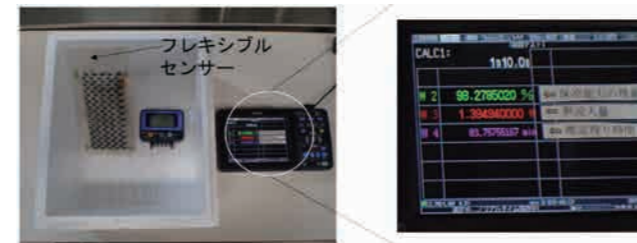
図2 保冷剤の残量計測システム
