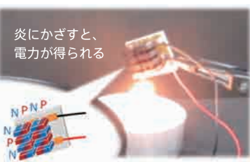
炎にかざすと、 電力が得られる Si系クラスレート 焼結体U字素子を用いた 熱電モジュール
