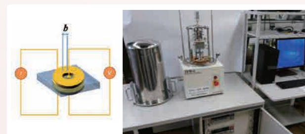
図1 装置外観と厚さ方向電気伝導度測定原理
