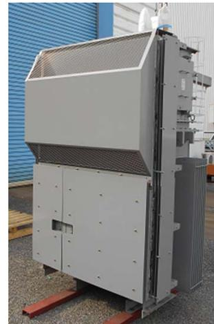
50Hz試作機 (300kVA, SiC使用)
