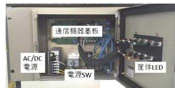
今回開発する機器と電圧制御システムをつなぐ通信端末とインターフェースを開発した。
