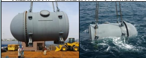
実証試験機浮体 耐圧構造モックアップ 水中吊架試験
