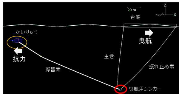
浮体係留シミュレーションモデルと固有周期推定結果
