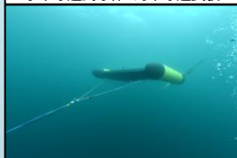
実証試験機浮体 耐圧構造モックアップ 水中吊架試験
