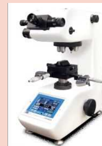
硬度検査(断面)
