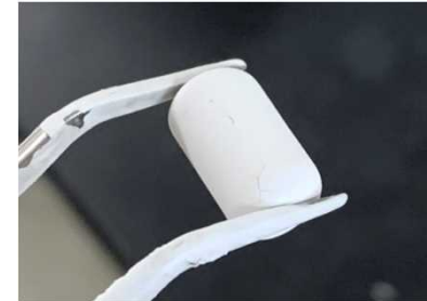
炭素鋼表面にアルミナ粉末を混合したアルミナゾルをコーティングした様子
