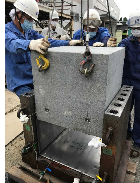
模擬地殻応力を負荷した 岩石ブロック掘削試験
