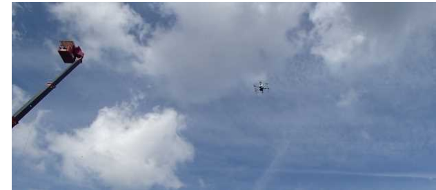
硫化水素測定は、高所作業車やUAVを用いて、地上高以外の高さでも実施。
