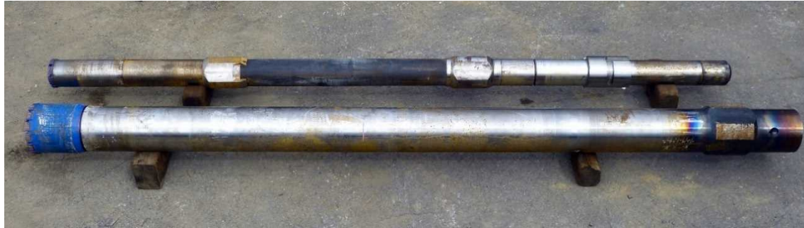
内溝ビットが付いた内バレル(上)および外溝ビットが付いた外バレル(下)
