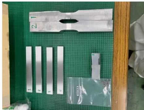
施工法試験片完成
