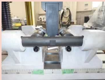
曲げ試験(側面)
