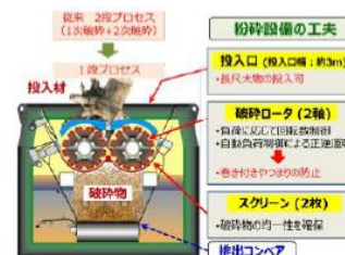
図 2.2.10 破碎設備の特徴とスペック
