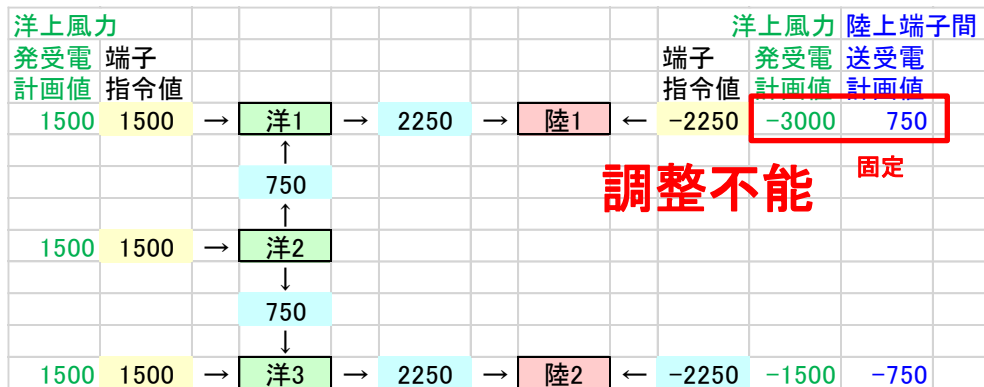
図7.12 パターン5：洋上風力発電計画および洋上風力受電計画（端子1）優先
