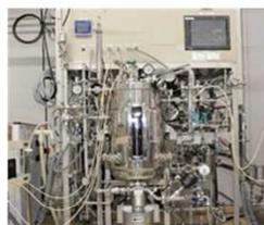
30L蒸気滅菌型培養槽
