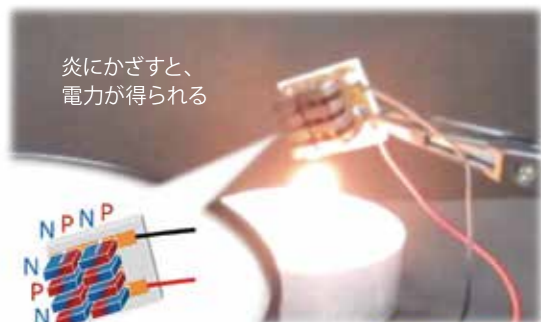
Si系クラスレート焼結体U字素子を用いた 熱電モジュール
