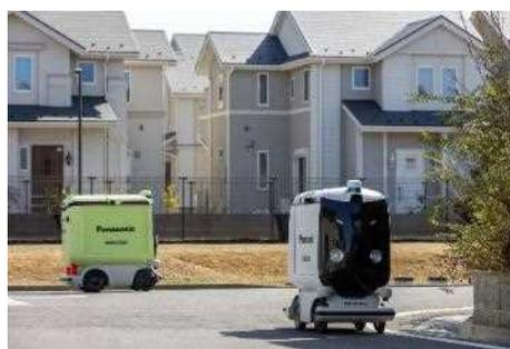
（参考）小型低速ロボットによる住宅街向け配送サービスの実証実験を Fujisawa サスティナブル・スマートタウンで実施
