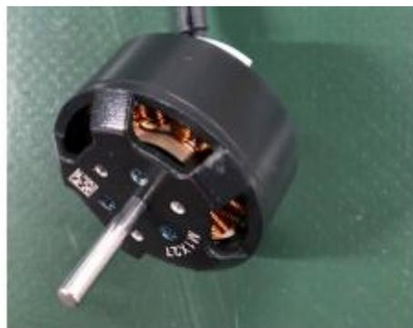
図 III- 3 4 ESC 基板とブラシレスモーター
