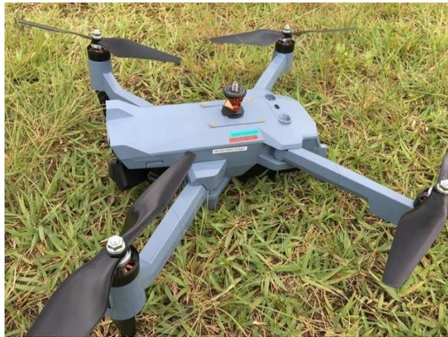
図 III-4 位置計測用プリズム
