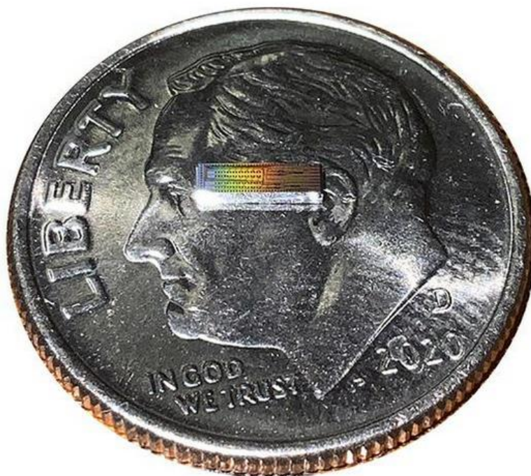
32 の個別の周波数チャンネルにデータをエンコードできるフォトニック集積チップと 25 セントとのサイズの比較 Credit: Lightwave Research Laboratory/Columbia Engineering
