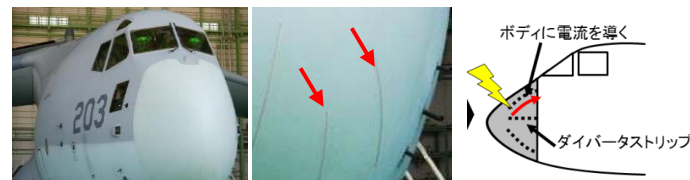
図1 航空機のダイバータストリップ
