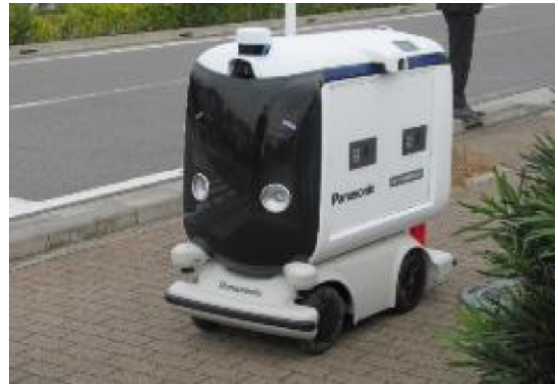
Fujisawa SSTでの小型低速ロボットによる配送
