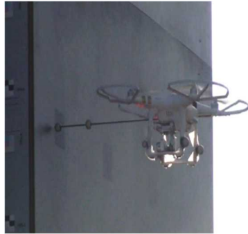
図 2.1.1.2-85 小型機 (Phantom3) への模擬打検棒の設置
