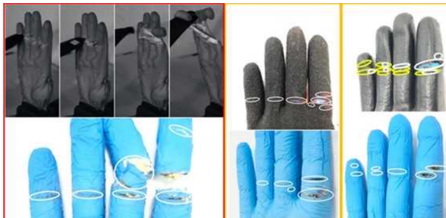
図 2.1.1.7-116 22[inch]のプロペラ（炭素繊維製、ストレート）による切創
