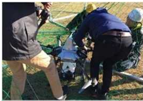
図 2.1.1.7-213 大型受止装置で受止めた機体の回収作業
