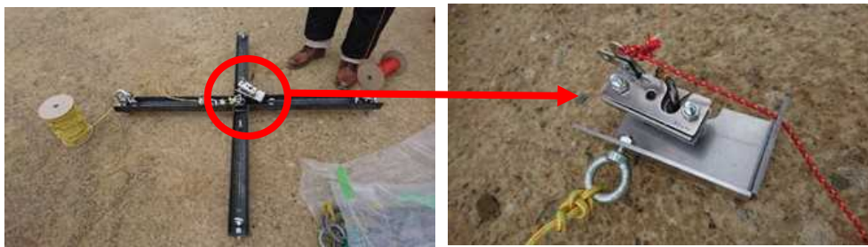
図 2.1.1.7-17 切り離し装置等(吊り下げ装置、切り離し装置)
