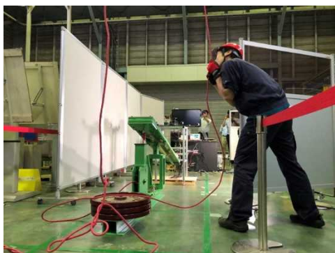
図 2.1.1.7-50 重りを落下させる様子
