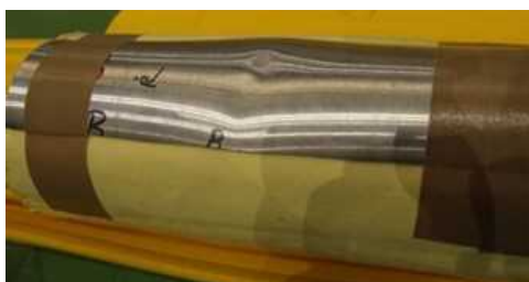
図 2.1.1.7-324 18m/s 衝撃試験後 写真 6 (ドローン①)
