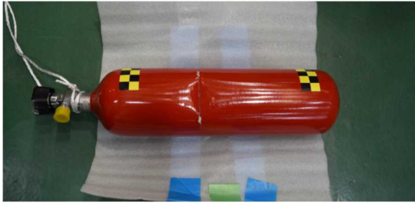
図 1-4-6-a-3.1 水素容器 衝撃試験後（容器①）
