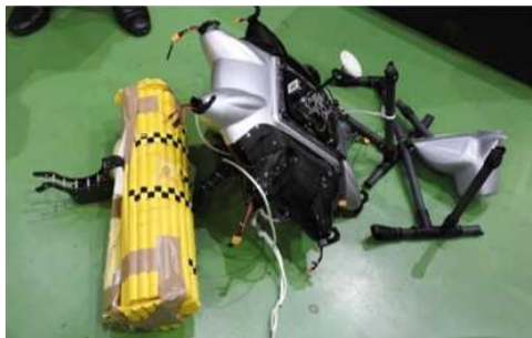
図 2.1.1.7-319 18m/s 衝撃試験後写真1（ドローン①）
