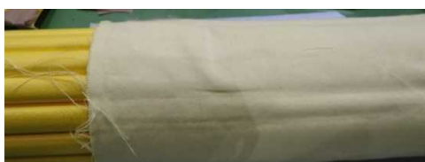
図 2.1.1.7-306 18m/s アングル衝撃 試験後写真 10 (保護付容器②)
