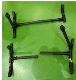
図 2.1.1.7-320 18m/s 衝撃試験後写真2（ドローン①）
