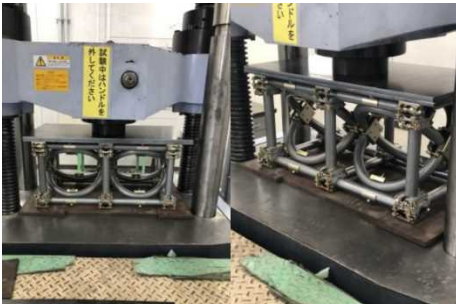
図 2.1.1.7-371 ユニット A 横の強度試験の様子と降伏塑性変形後の形状
