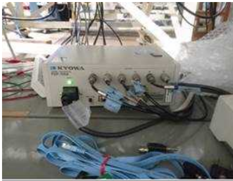
図 2. 1. 1. 7-191 ロードセルからのデータ入力
