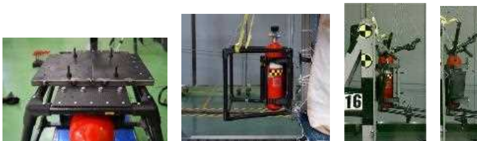
図 1-4-6. 6. 9-1 カーボンフレーム④ ウェイト設置写真と衝突写真
