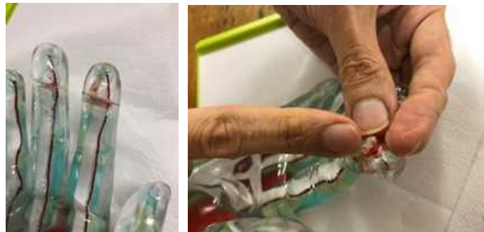
図 2.1.1.7-118 手指ダミーの損傷
