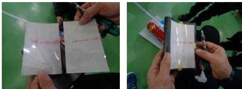
図 1-8-2.16 圧力測定フィルムと保護材に取り付けた圧力測定フィルム
