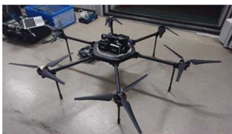
図 2. 1. 1. 7-184 3 枚プロペラを取り付けた機体
