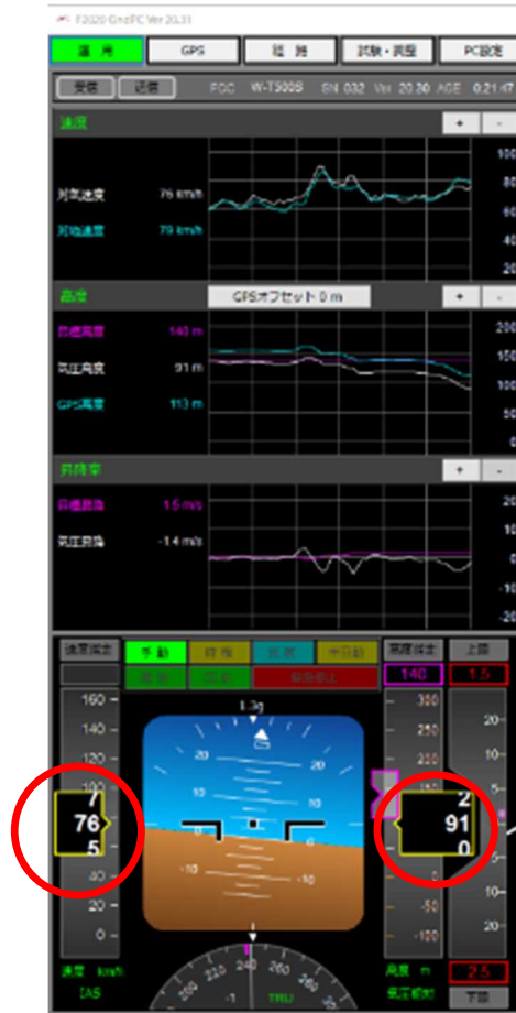
図 1-5-4-5 飛行試験時の計器画面の速度表示（左）と高度表示（右）
