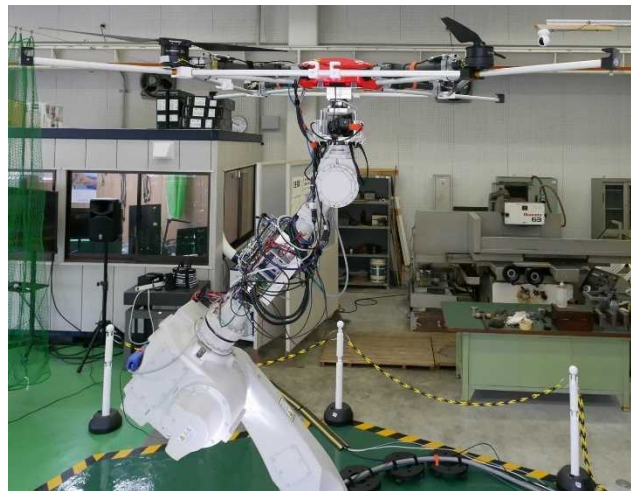
図 1-4-3-c-1.1 ドローンアナライザーに設置した外観写真
