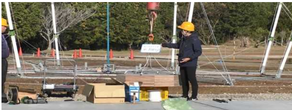
図 2.1.1.7-205 ダミードローン重量計測 (100kg)
