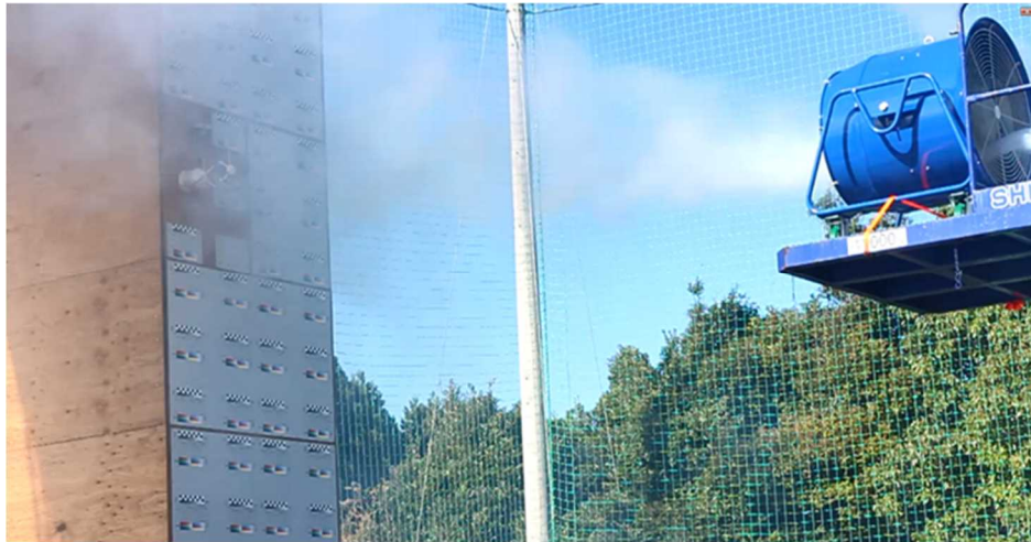
図 2.1.1.2-114 発煙筒による人工流の見える化例
