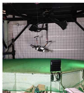
図 2.1.1.7-156 落下終端速度・ 姿勢観測試験 (PF-2 背面 40 度傾斜プロペラフリー)
