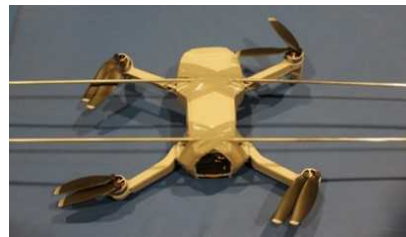
図 2.1.1.7-98 治具を取り付けた 200g ドローン例 2
