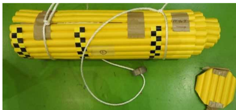
図 2.1.1.7-281 18m/s 垂直衝撃試験後 写真 1 (保護付容器①)
