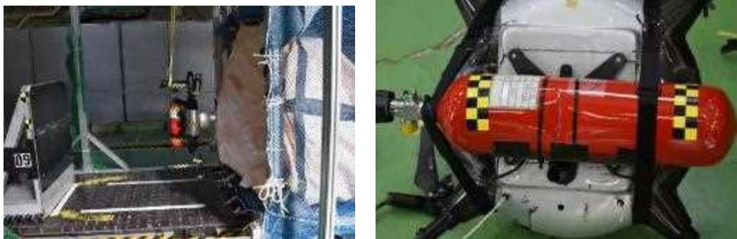
図 1-4-6.5.6-1 小型ドローン（底面）衝撃試験前後の写真
