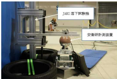
図 2.1.1.7-67 JARI 落下試験機に 安衛研計測装置を設置した状態
