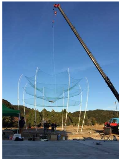
図 2.1.1.7-206 25kg ダミードローン動的落下試験風景
