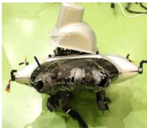
図 2.1.1.7-333 18m/s 衝撃試験後 写真 1（ドローン②）
