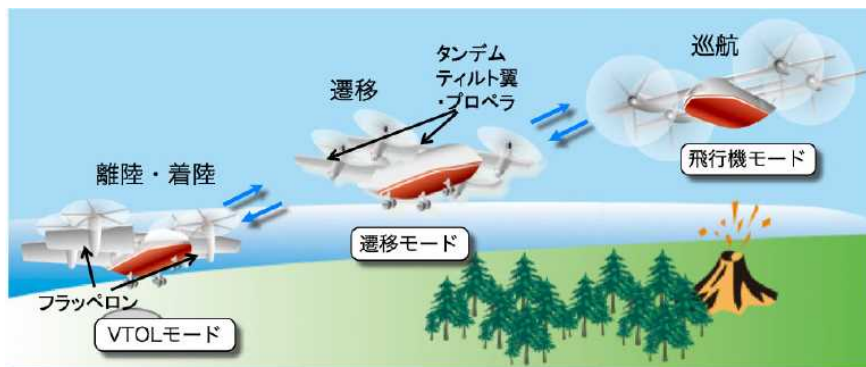
図 1-5-1-a. 3 QTW 無人航空機の飛行形態
