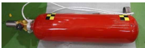
図 2. 1. 1. 7-268 18m/s 水平衝撃試験後 写真 1 (容器①)
