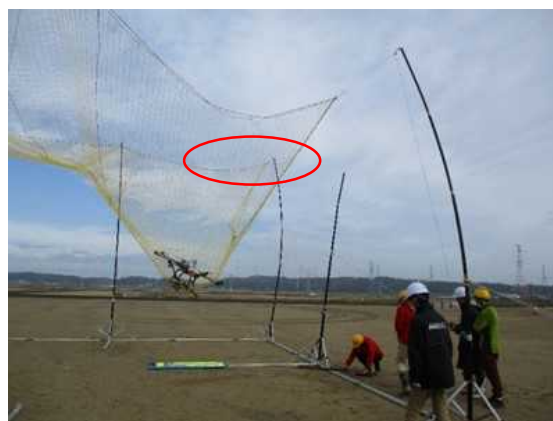
図 2. 1. 1. 7-32 PRODRONE X-F1 落下試験
