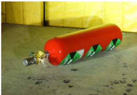
図 2. 1. 1. 7-226 垂直落下試験後写真 1 (全体)
