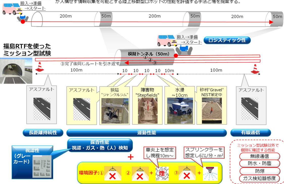
図 2. 1. 1. 5-4 トンネル災害を想定したミッション型試験の考え方
