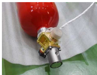
図 2. 1. 1. 7-276 18m/s 垂直（バルブ） 衝撃試験後写真
