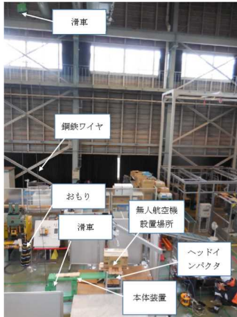
図 2.1.1.7-71 試験方法 2 で使用する安衛研射出試験機の全体図
