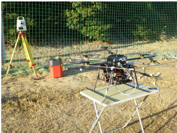
図 2.1.1.2-84 中型機（ACSL-PF1）への模擬打検棒の設置
