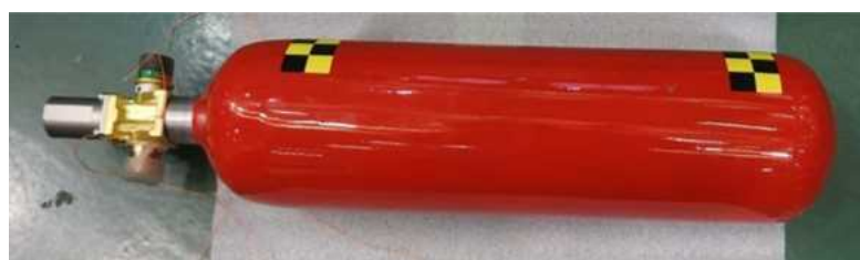
図 2. 1. 1. 7-255 7. 7m/s 水平衝撃試験後写真 2（衝撃部位）
