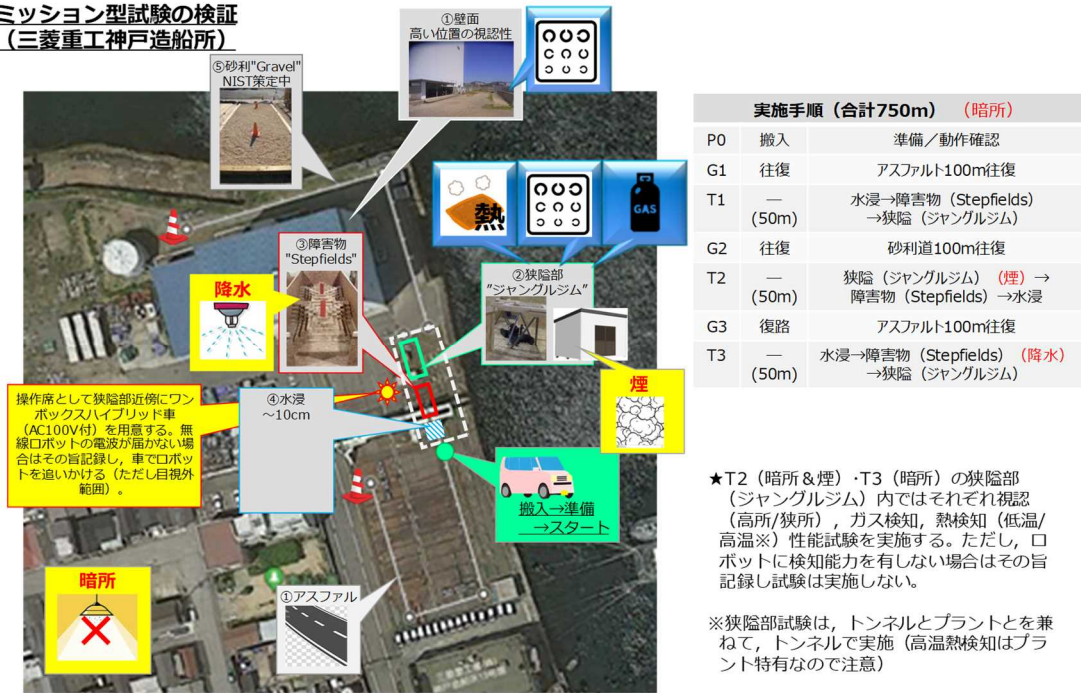
図 2. 1. 1. 5-11 トンネル災害想定ミッション試験の検証方法
