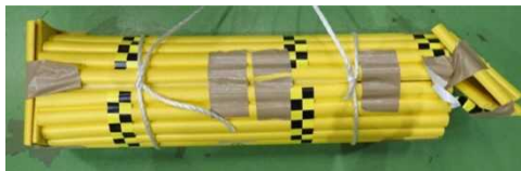
図 2. 1. 1. 7-311 18m/s 垂直 (バルブ) 衝撃試験後写真 1
