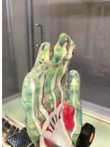
図 2.1.1.7-120 手指ダミーの損傷（検証試験結果）
