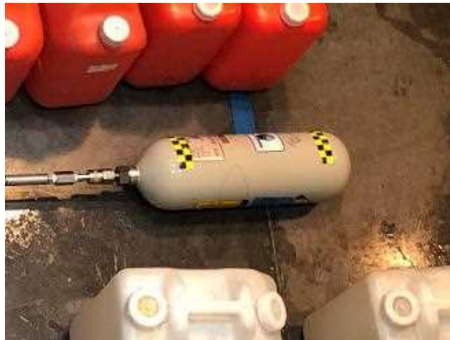
図 1-8-3.9 試験用加圧ホースに供試体が接続された状態
