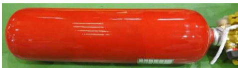
図 2.1.1.7-294 18m/s 水平衝撃試験後写真 9 (保護付容器②)
