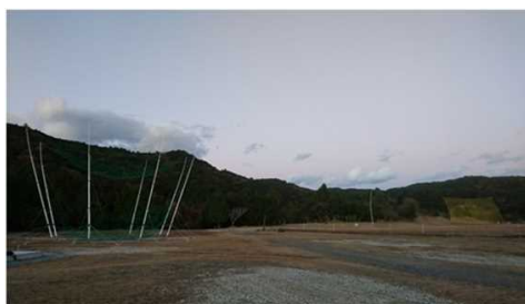
図 2. 1. 1. 7-384 ホーペック鳥羽工場に設置された 大型無人航空機落下受止装置（左）と 無人航空機用落下受止装置（水平飛行からの落下受止装置）（右）
