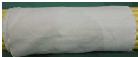
図 2. 1. 1. 7-293 18m/s 水平衝撃試験後 写真 8（保護付容器②）
