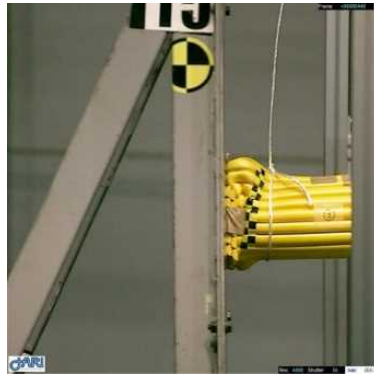
図 2.1.1.7-315 18m/s 垂直（バルブ）衝撃試験高度カメラ写真 （最大変形時）
