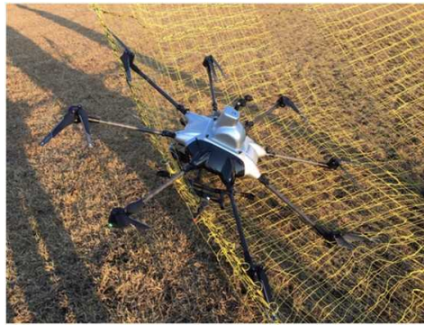
図 2. 1. 1. 7-220 水平飛行からの落下 試験で受止装置で受け止められたが、 ネット上の落下位置が低すぎたため、 地面に衝突して破損した X-F1
