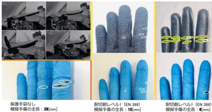
図 2.1.1.7-115 15[inch]のプロペラ（炭素繊維製、折り畳み）による切創
