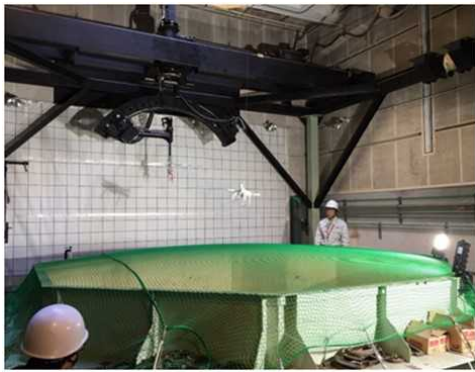
図 2.1.1.7-159 落下終端速度・ 姿勢観測試験 (Phantom3 水平プロペラ無し)
