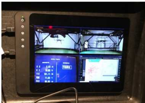
図 2.1.1.7-149 録画システム表示画面 (操作卓、正面、横方向、(VRSは機体 操縦画面も)を時刻同期で表示可能)
