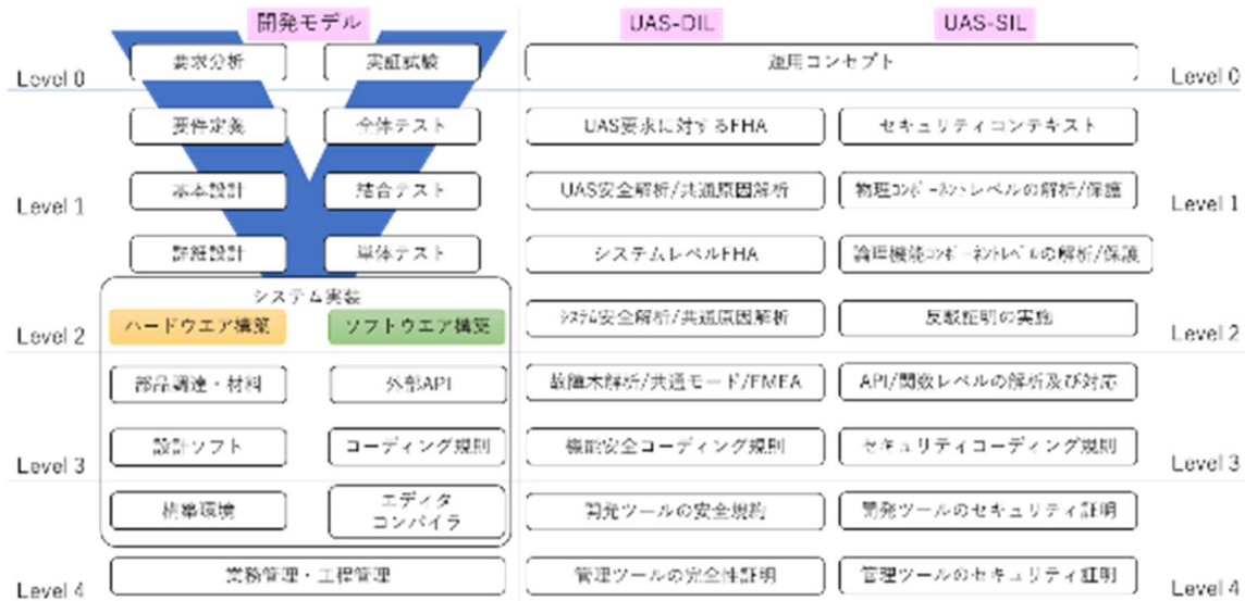
図 ②2-12 UAS に対するデザイン完全性レベルとセキュリティ完全性の定義案 表② 2-4 地上リスクと保障レベルに基づく完全性レベルの定義
