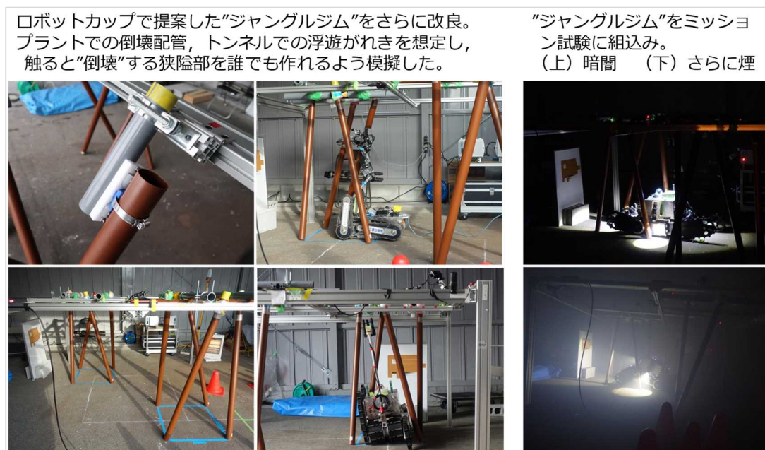
図 2. 1. 1. 5-14 “ジャングルジム” 実装検証の様子
