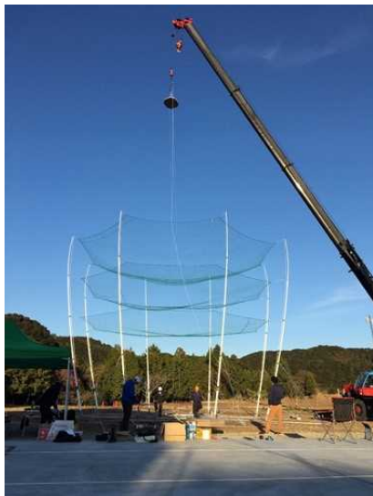
図 2.1.1.7-206 25kg ダミードローン動的落下試験風景
