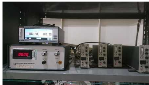
図 2. 1. 1. 7-191 ロードセルからのデータ入力
