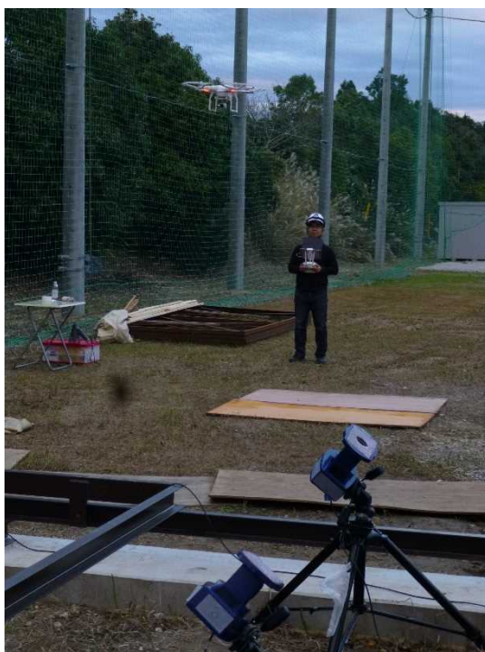
図 2.1.1.2-87 小型ドローン (Phantom3) の飛行位置測定検証
