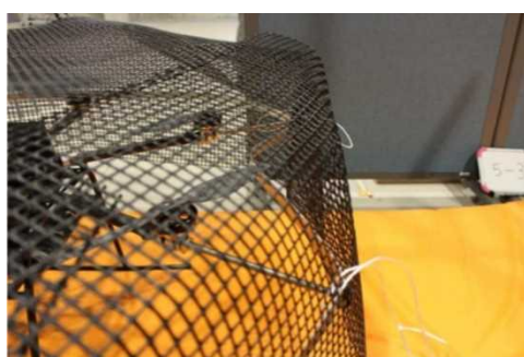
図 2.1.1.7-103 衝突により変形した PF-1 のガード
