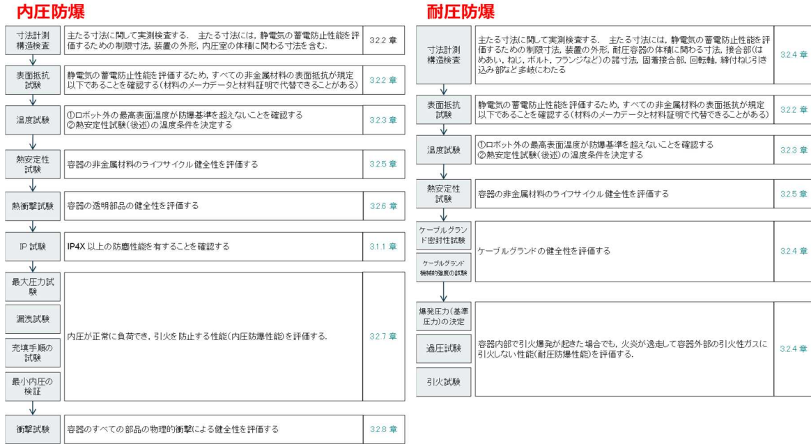
図 2.1.1.5-8 ロボット用としての防爆規格適用試験の概要
