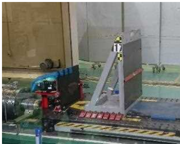
図 1-8-2.6 衝突台にアングルを取り付けた状態
