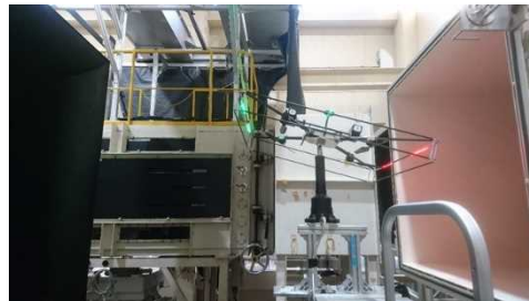
図 2.1.1.7-195 機体の取り付け状態 (10度傾斜)
