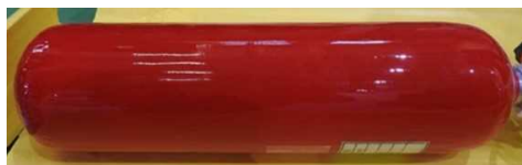
図 2. 1. 1. 7-289 18m/s 水平衝撃試験後 写真 4（保護付容器①）
