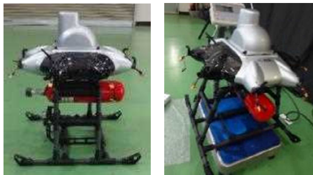
図 1-8-2.11 水素燃料容器搭載用機構のついた機体の例
