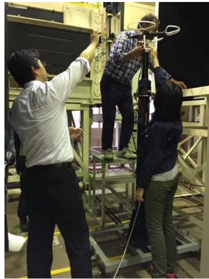
供試体の試験架台への取付
