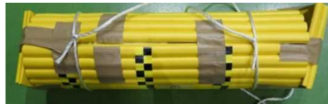
図 2.1.1.7-282 18m/s 垂直衝撃試験後 写真 2 (保護付容器②)
