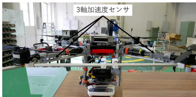
図 1-4-3-d-1.2 加速度センサの設置位置
