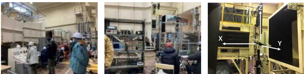
図 1-5-5-6 ドローンの速度限界計測風洞試験
