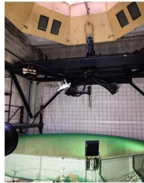
図 2.1.1.7-160 落下終端速度・ 姿勢観測試験 (Phantom3 背面プロペラ無し)
