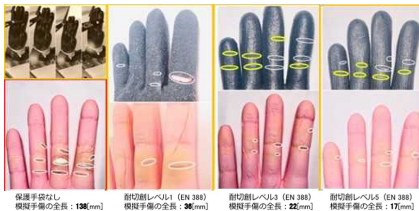
図 2.1.1.7-114 15[inch]のプロペラ（炭素繊維製、ストレート）による切創
