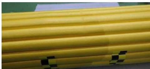
図 2.1.1.7-304 18m/s アングル衝撃 試験後写真 8 (保護付容器②)
