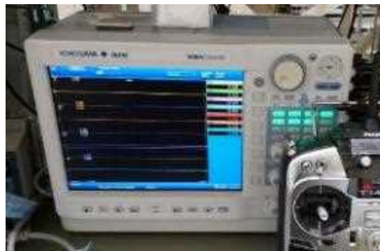
写真 1-5-6-44 ロードセルからの力覚データ表示・記録装置
