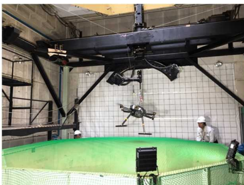
図 2.1.1.7-155 落下終端速度・ 姿勢観測試験 (PF-2 水平プロペラフリー)
