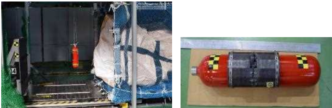
図 3.4.6-1 保護付き水素容器衝撃試験前と後の写真（保護材①）
