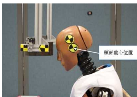
図 2.1.1.7-84 人体ダミー頭部に衝突させる位置
