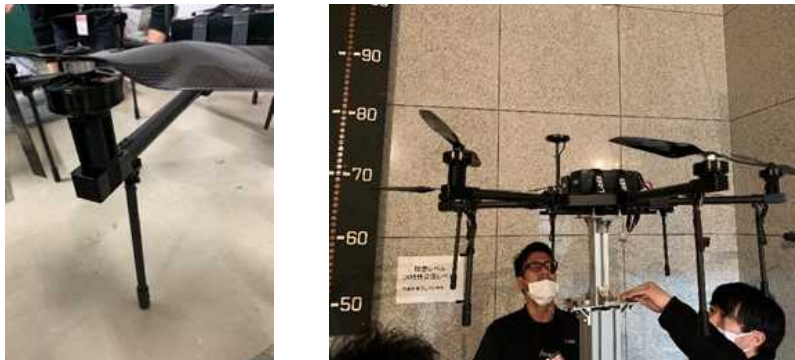
図 2. 1. 1. 7-180 機体設置風景 (プロペラ回転面に段差)
