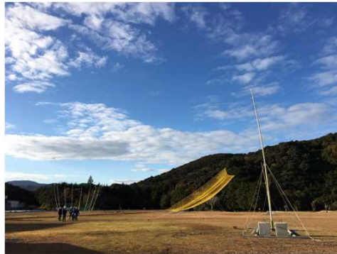
図 2. 1. 1. 7-217 水平飛行からの落下 試験用受止装置（横から見た図）
