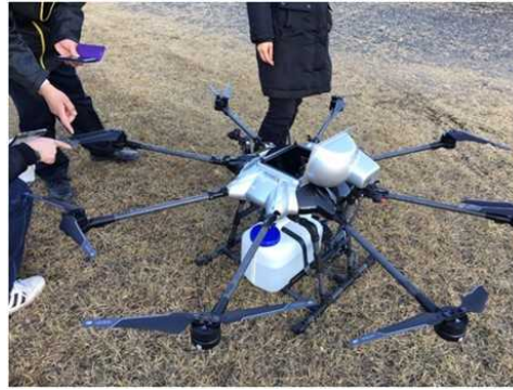
図 2.1.1.7-215 垂直落下試験で プロペラが破損した X-F1
