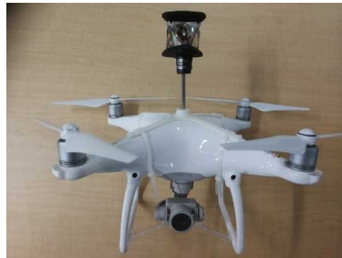
図 2.1.1.2-17 ATP2S 設置(小型機)
