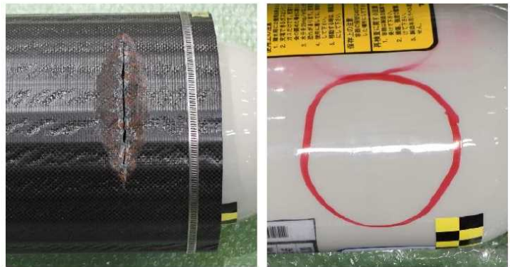
図 1-4-6-b-3.2 保護材衝撃試験後写真（容器①-4+保護材 A_試験 No. 21）
