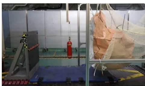
図 2.1.1.7-257 7.7m/s アングル衝撃 試験前写真
