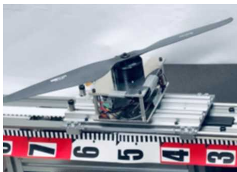
図 2. 1. 1. 7-108 実験装置 (プロペラの射出台車)
