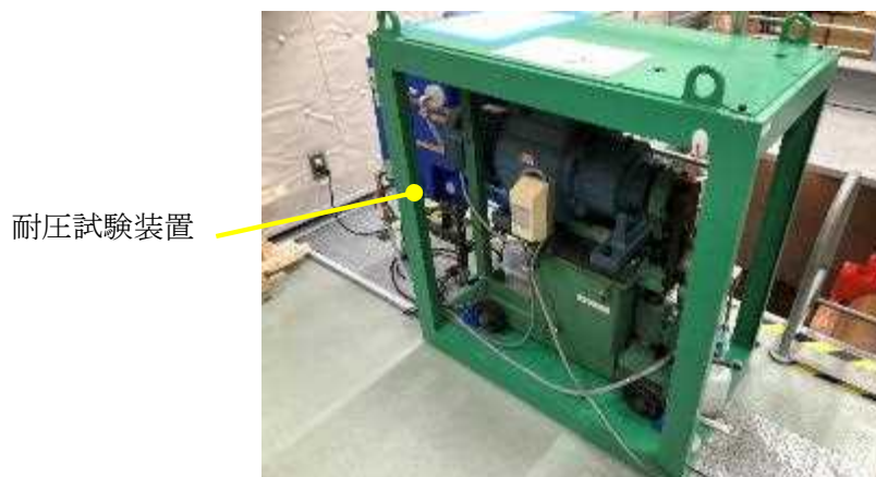
図 1-8-3.12 耐圧試験装置 外観
