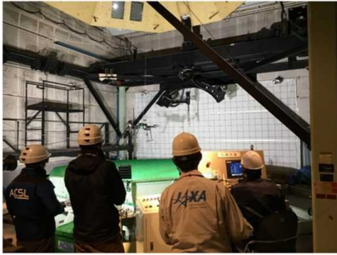
図 2.1.1.7-157 ボルテックスリング 現象観測試験の様子 (PF-1)
