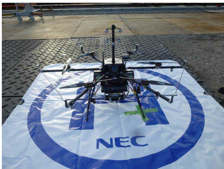
図 2.1.1.2-71 中型機 (ACSL-PF1) への模擬打検棒の設置
