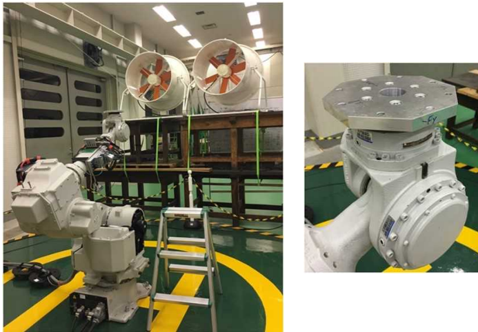
図 2.1.1.7-142 試験装置とロードセル拡大図
