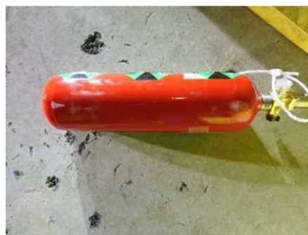
図 2.1.1.7-235 水平落下試験後写真 2 (落下衝撃部位 1)
