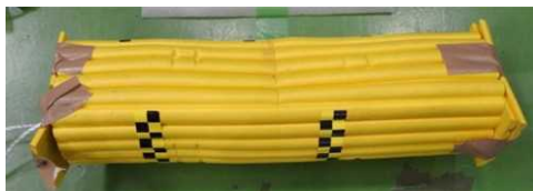
図 2.1.1.7-297 18m/s アングル衝撃 試験後写真 1 (保護付容器①)
