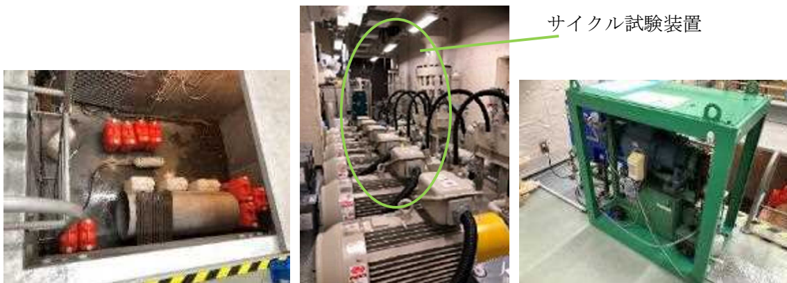
図 1-8-3.3 試験ピット例全体例 図 1-8-3.4 サイクル試験装置例 図 1-8-3.5 耐圧試験装置例
