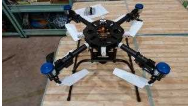
写真 1-5-6-2-1 ピッチ可変機構付き回転翼機
