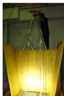
図 2.1.1.7-240 アングル落下試験前写真2 (高さ 3m 確認)
