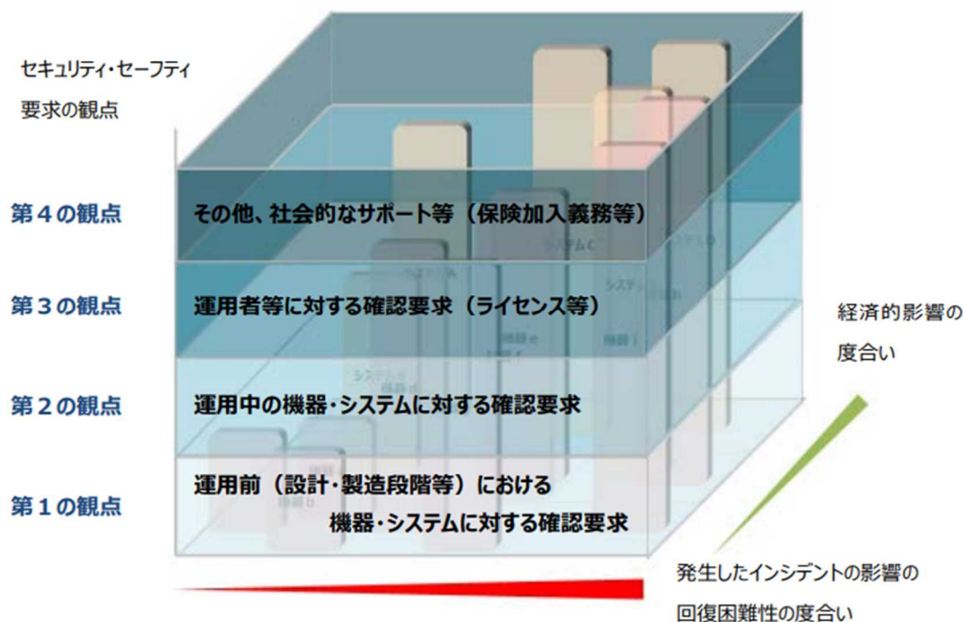
図-15 カテゴリに応じて求められるセキュリティ・セーフティ要求の観点のイメージ (出典：経済産業省「IoTセキュリティ・セーフティ・フレームワーク (IoT-SSF) Ver1.0」 34) )
