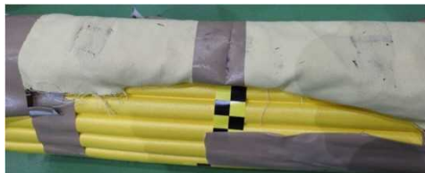
図 2.1.1.7-321 18m/s 衝撃試験後写真3（ドローン①）
