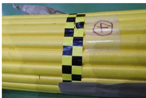
図 2.1.1.7-323 18m/s 衝撃試験後 写真 5 (ドローン①)
