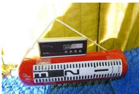
図 2.1.1.7-239 アングル落下試験前写真1 (水平確認)
