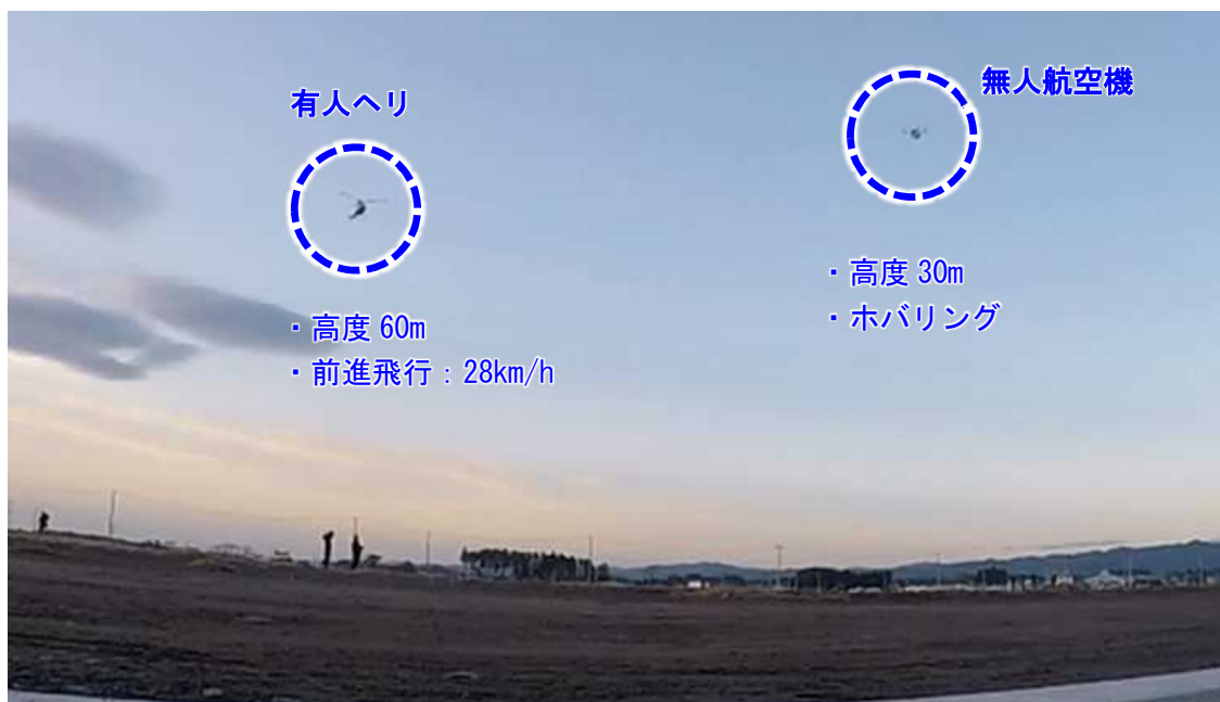
図 2.1.1.4-9 ダウンウォッシュ影響確認試験－前進飛行試験実施状況
