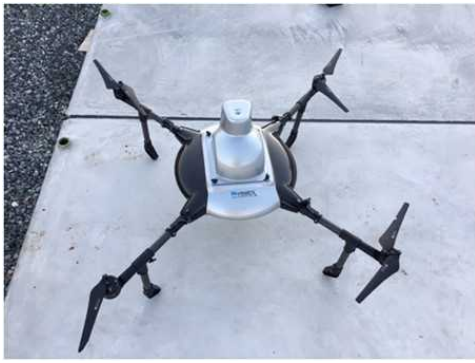
図 2.1.1.7-387 試験でプロペラが 破損した X-S1
