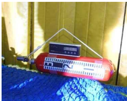
図 2.1.1.7-232 水平落下試験前写真 1 (水平確認)
