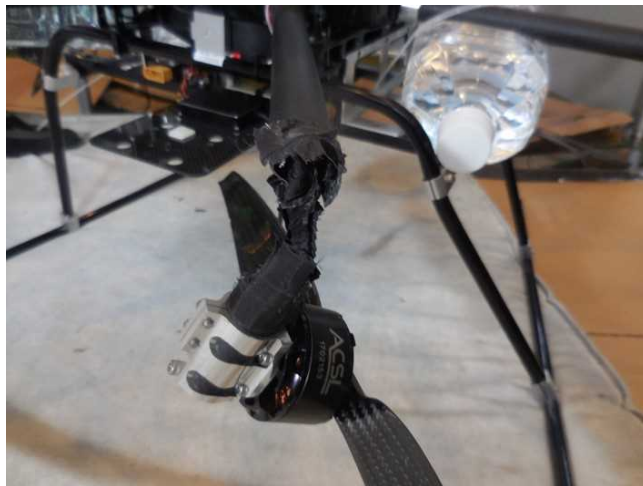
図 2.1.1.7-59 試験後の供試体 (アームへのHI 衝突によるアームの破壊)
