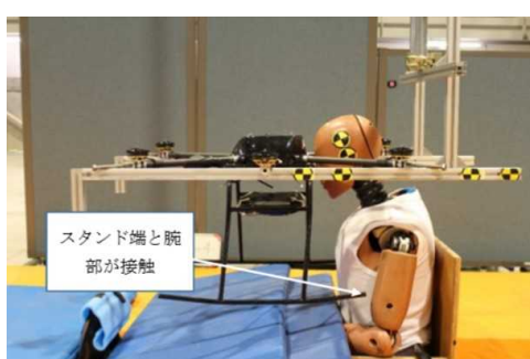
図 2.1.1.7-105 PF-1 ガードなしの衝突の状況
