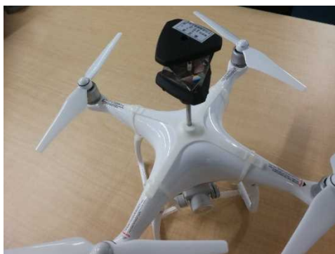
図 2.1.1.2-16 ATP2S 設置(小型機)1
