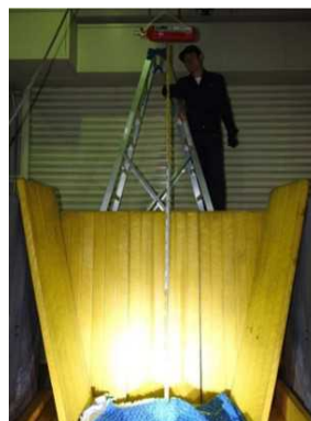
図 2.1.1.7-233 水平落下試験前写真 2 (高さ 3m 確認)
