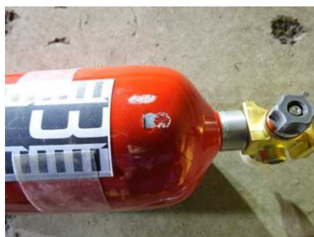
図 2.1.1.7-236 水平落下試験後写真 3 (落下衝撃部位 2)
