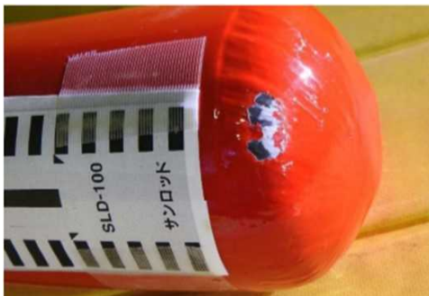
図 2. 1. 1. 7-228 垂直落下試験後写真 3 (落下衝撃部位 2)
