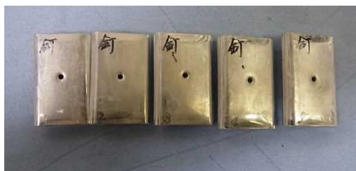
図 1-4-2-f-1 釘刺し試験を実施したバッテリー
