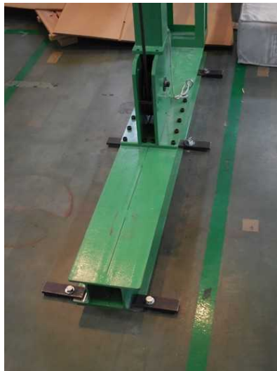
図 2.1.1.7-55 アンカー止めされた投頭機台座部
