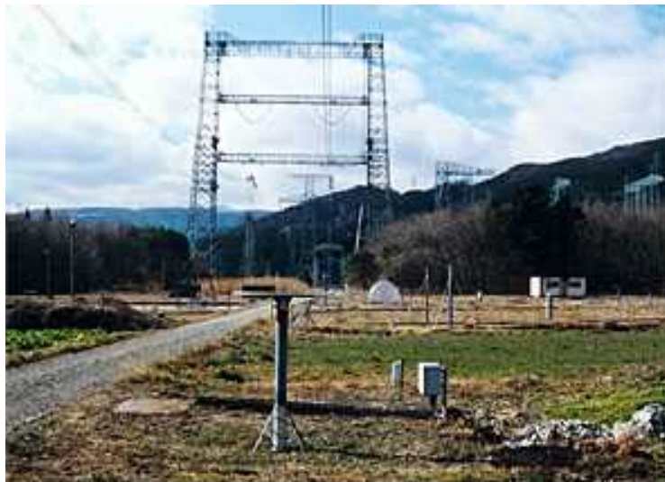
試験送電線とイオン流帯電現象の測定装置
