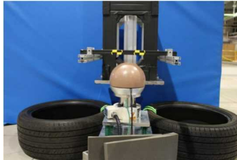
図 2.1.1.7-68 おもりの設置状況
