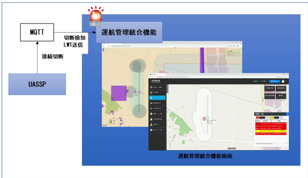
図 2. 2. 1. 10-78 UASSP 障害発生監視部プロトタイプを用いた実証試験の成果 (出典 : openstreetmap.org)
