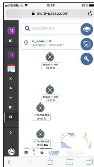
図 2. 2. 1. 3-29 移動体端末間通信モジュール及び多用途運航管理システムを經由してスマートフォンの画面に表示された各ドローンの位置
