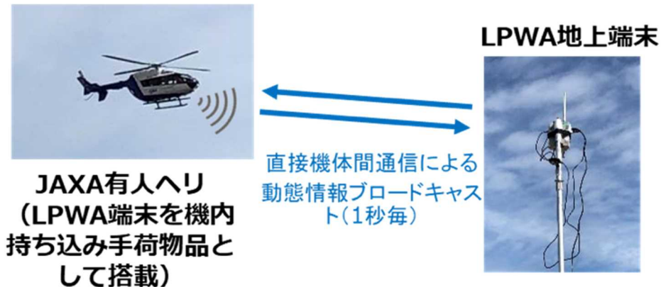
図 2.2.1.9-52 LPWA 端末（マルチ通信端末）の有人ヘリへの搭載と地上端末の設置の様子
