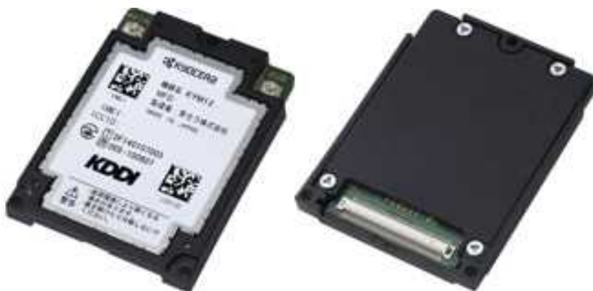
図 2.2.1.2-16 LTE モジュール「KYM12」外観
