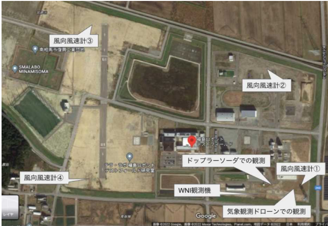
図 2. 2. 1. 10-152 福島 RTF 観測機配置場所
