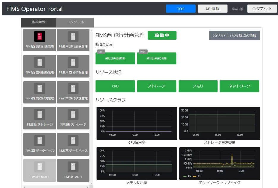
図 2. 2. 1. 10-56 FIMS 運用状況監視ポータルサイト (システム管理者向けページ)
