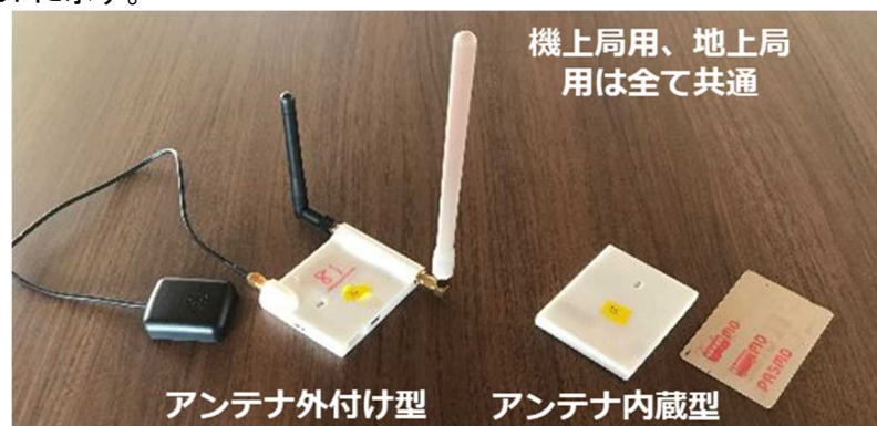
図 2.2.1.9-49 マルチ通信端末小型機 (白いアンテナは LPWA、黒いアンテナは BLE、ADS-B に不対応)
