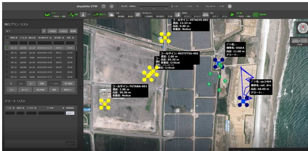
図 2. 2. 1. 4-15 UTM 上で他コンソ（黄色マーク）と自コンソ（青マーク）のリアル飛行データの表示
