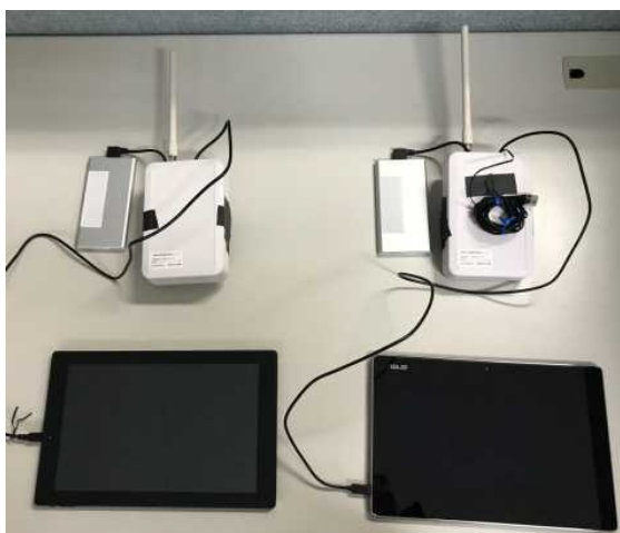
図 2.2.1.3-23 位置情報共有技術を実装した移動体端末間通信モジュールと共有情報モニタ用タブレット
