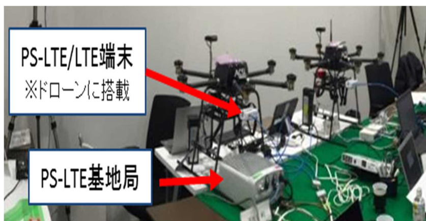
図 2. 2. 1. 1-12 PS-LTE/LTE マルチ接続通信環境
