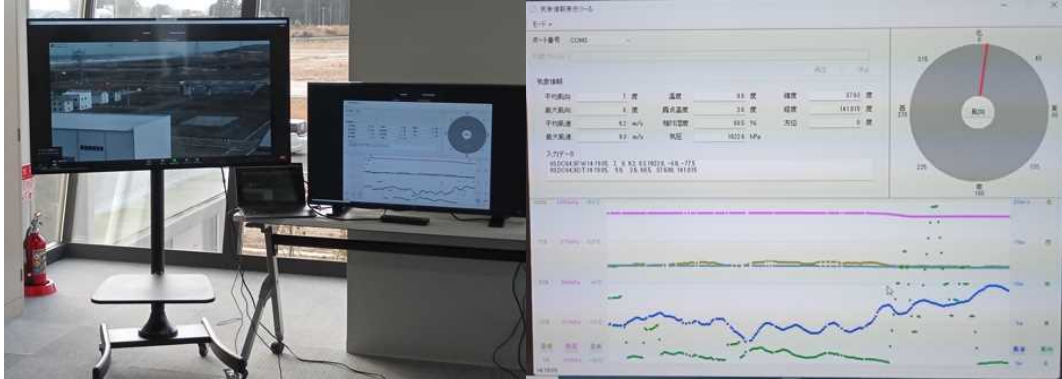
統合管制室にて設置した気象観測
