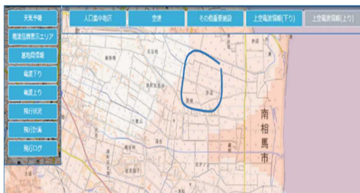
図 2.2.1.1-11 携帯電波情報の可視化および飛行計画策定への反映
