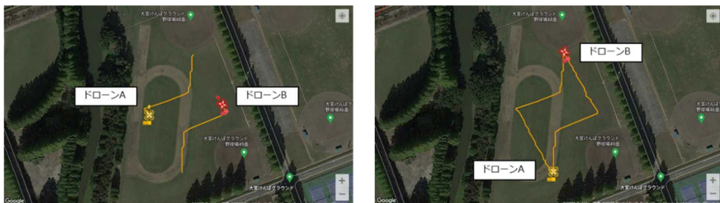
図 2. 2. 1. 9-60 機体間通信による 2 機のニアミス回避実験結果
