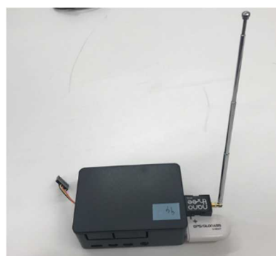
図 2.2.1.9-50 マルチ通信端末汎用機 (GPS と LPWA アンテナは内蔵、写真のアンテナは ADS-B 受信用、 白の Dongle は BLE5 送受信用)
