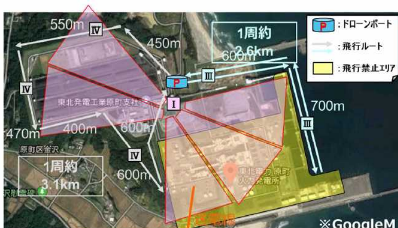
図 2. 2. 1. 2-25 広域重要設備内の災害監視の実証試験の飛行経路
