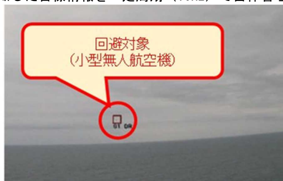
※定量的な評価試験において小型無人航空機を回避に必要な離隔距離である 250m 以遠で捉えている画像 図 2.2.1.11-6 小型無人航空機探知時の画像
