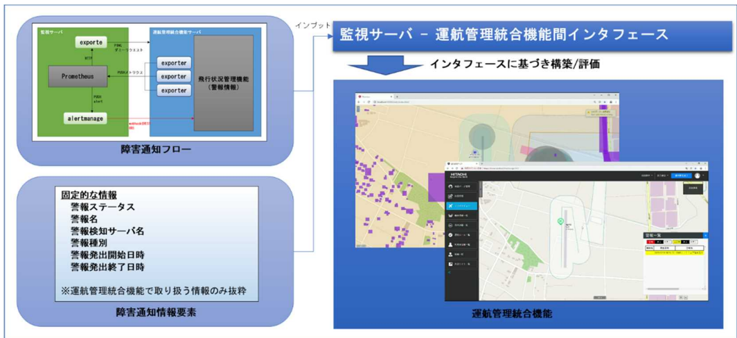
図 2. 2. 1. 10-75 監視サーバ、運航管理統合機能間の構成イメージ (出典 : openstreetmap.org)
