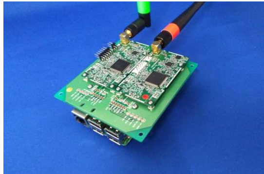
RF モジュールを接続した様子
