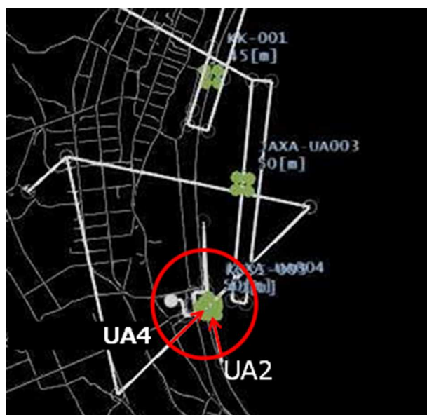
図 2.2.1.14-130 フライト B1 (03/06 11:22:59) UA2 が野良ドローンを回避してホバリング (14m)
