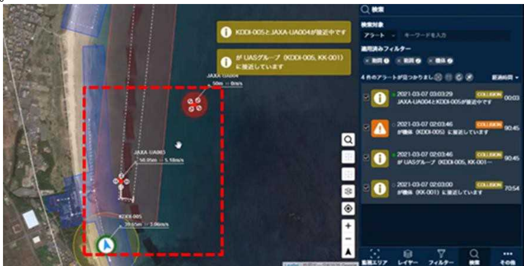
図 2.2.1.14-127 KDDI ドローン(実機)と JAXA ドローン(シミュレータ)の近接時アラート
