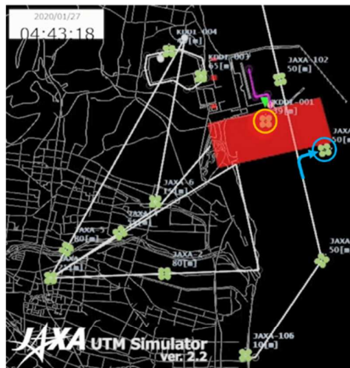
図 2. 2. 1. 8-10 相互接続試験の飛行計画に対するシミュレーション評価
