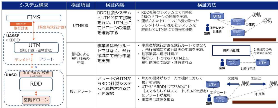
図 2. 2. 1. 14-33 他社飛行制御システムとの接続
