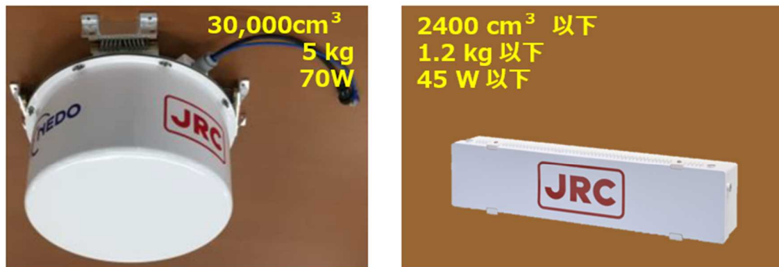
開発した小型化、軽量化、低消費電力化した電波センサ
