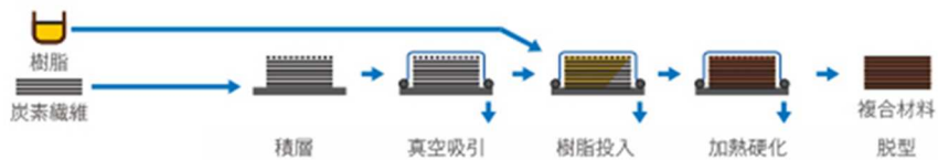
図 2.4.2-13 従来のオートクレーブ法（上）と新規開発した A-VaRTM 法（下）
