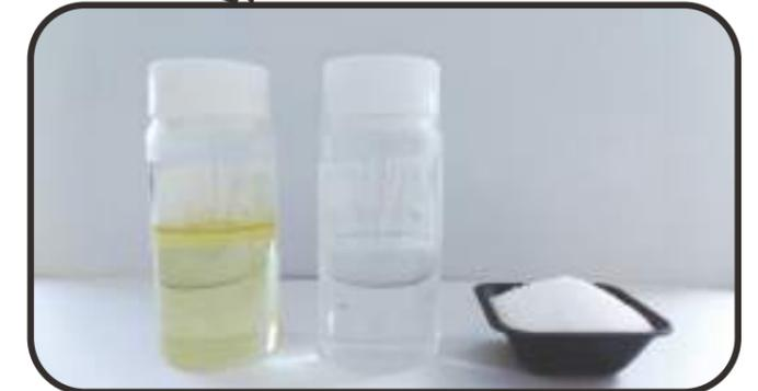
マイクロ波を利用し、廃棄プラスチック（ポリスチレン）から得た分解オイル（写真左）。分解オイルからスチレンモノマー（中央）を回収、精製・再生することで再生ポリスチレン（右）を生成。
