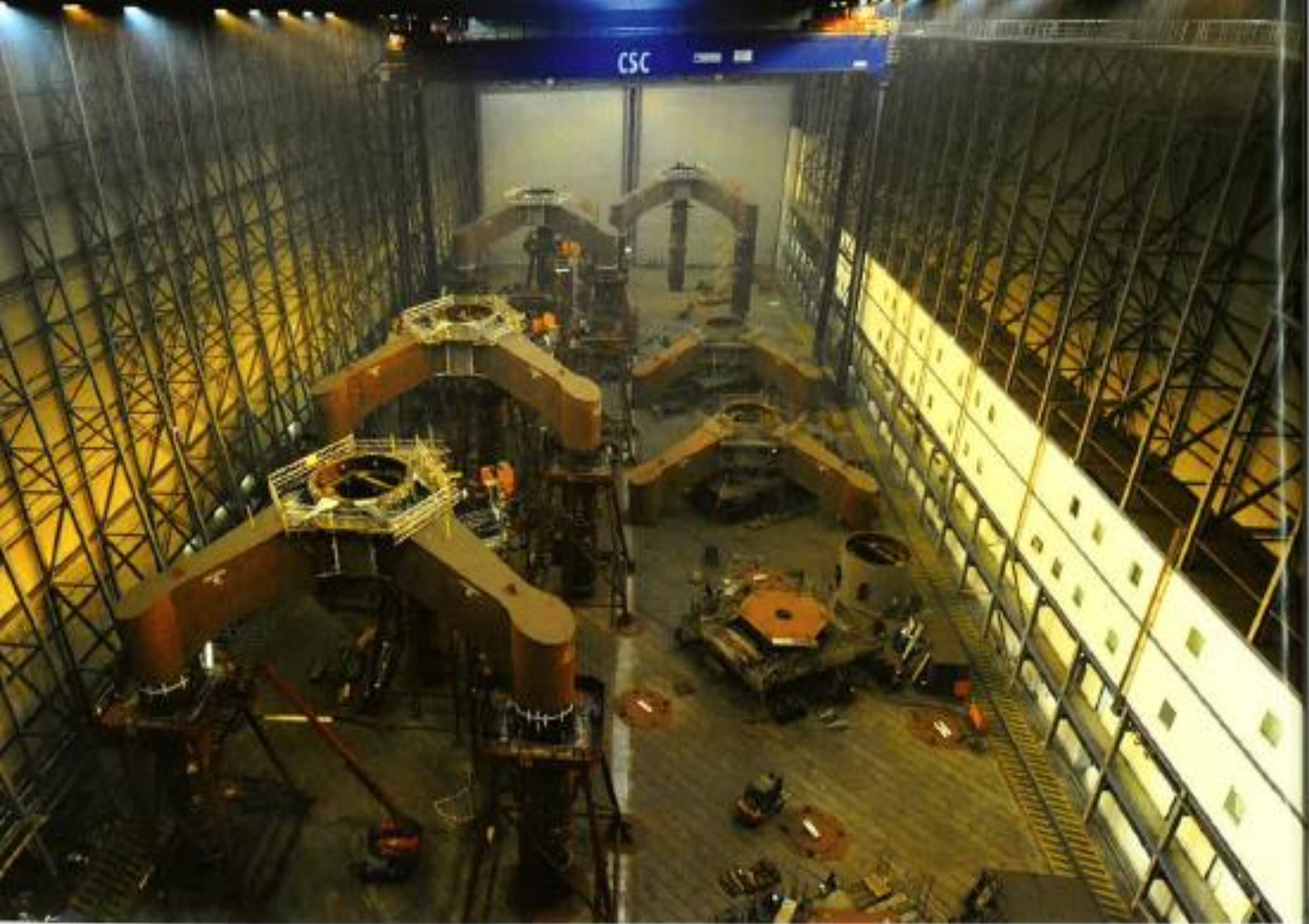
トライポッド(土台)を製造する工場内の様子
