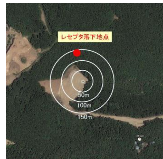
図 3 6号風車レセプタ脱落地点
