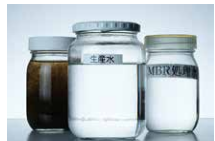
写真 1 処理前の下水（左）、MBR 処理後の水（右）、統合システムでの最終生産水（中央）
