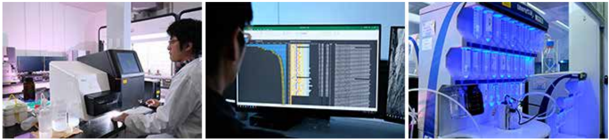
写真1 「PDPS」を含む、標的タンパク質に対する「特殊ペプチド」探索・合成のプロセス。標的タンパク質をシーケンサに入れるとタンパク質が約1兆の「特殊ペプチド」群から活性の高いものを“ディスカバリー”する（左）、その結果はコンピュータ・ディスプレイに表示され（中央）、選択した「特殊ペプチド」が合成される（右）
